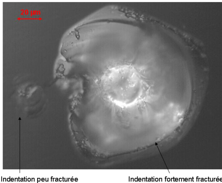
**Figure 66 : Image obtenue avec un microscope Nomarski montrant à gauche une indentation peu fracturée et à droite une indentation fortement fracturée. Les deux indentations sont faites dans les mêmes conditions.**
