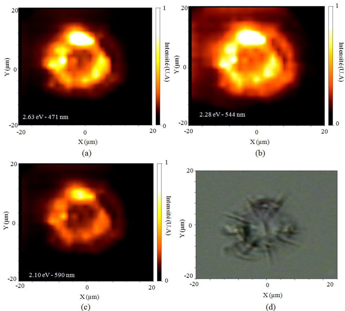
**Figure 99 : Cartographies de photoluminescence obtenues sur les indentations sous excitation à 3,81 eV (325 nm) ; (a) émission à 2,25 eV, (b) émission à 2,75 eV, (c) cartographie pour l'émission à 2,10 eV, (d) image de microscopie optique en transmission de l'indentation étudiée.**
