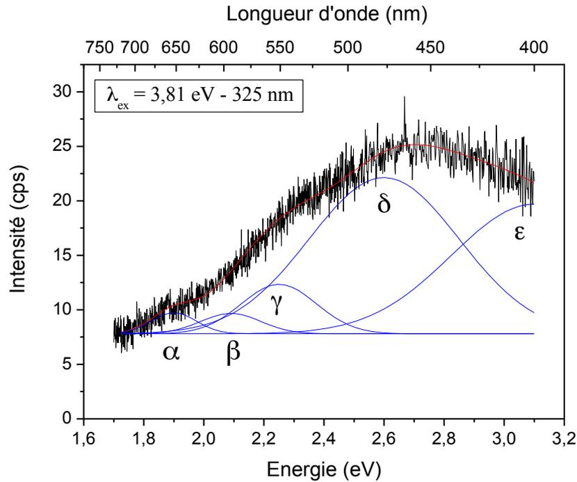
**Figure 95 : Spectre de photoluminescence obtenu pour la silice vierge sous excitation à 3,81 eV (325 nm).
