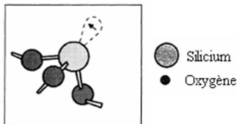
Figure 8 : Représentation schématique du centre E' (d'après [25]).
