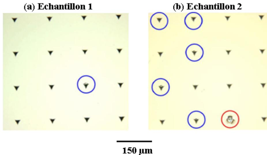
**Figure 67 : Images des indentations réalisées sur les deux échantillons avec la même force. (a) une seule indentation présente une écaille entourée en bleu. (b) Cinq indentations sont cassées, entourées en bleu, et une indentation est explosée, entourée en rouge [88].**
