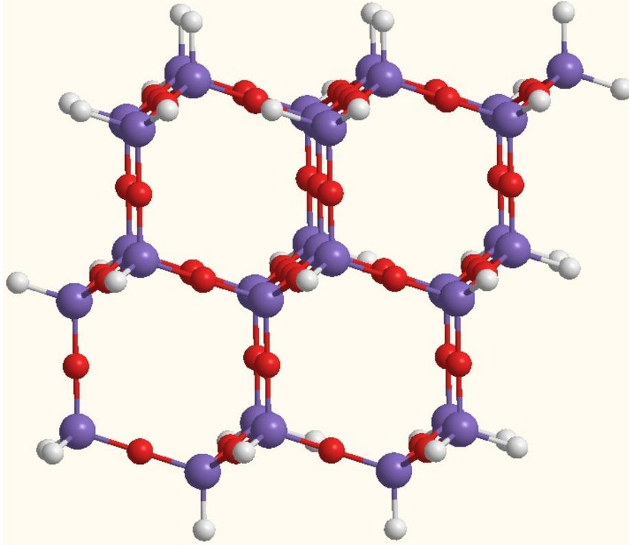
**Figure 33.** Morceau de  $\alpha$ -cristobalite idéale ; les atomes de silicium sont représentés en bleu et ceux d'oxygène en rouge, les liaisons Si-O-Si sont rectilignes et la densité est égale à celle de la silice vitreuse. Les liaisons périphériques sont saturées par des atomes d'hydrogène représentés en blanc. La structure est formée à partir d'un assemblage de cycles Si-O hexagonaux.
