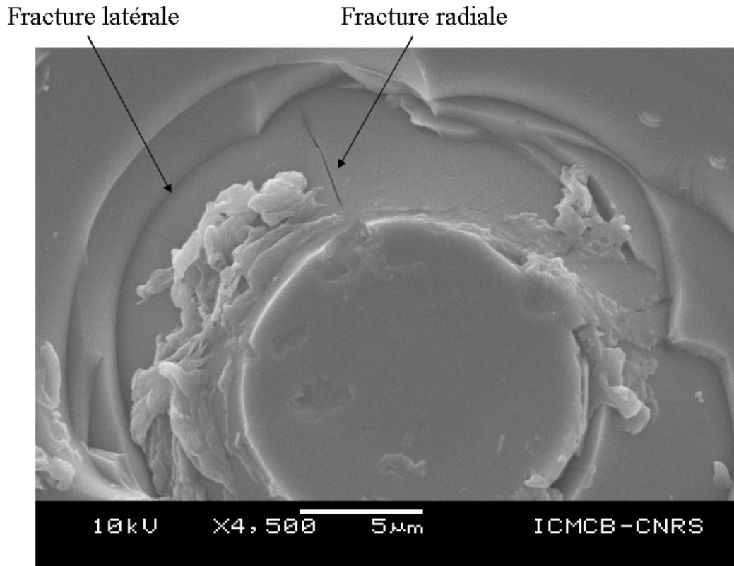
Figure 69 : Image en microscopie électronique d'une indentation.
