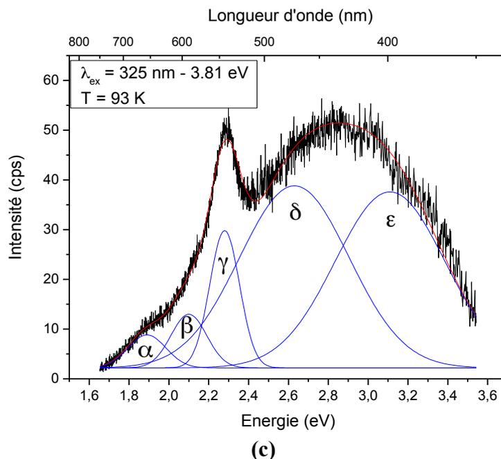
**Figure 110 : Spectres de photoluminescence sous excitation à 3,81 eV (325 nm) obtenu sur une indentation (site de type  $I_{ind}$ ). (a) 293 K. (b) 193 K. (c) 93 K. En noir : données expérimentales ; En rouge : ajustement global du signal ; En bleu : Composantes gaussiennes du signal.**
