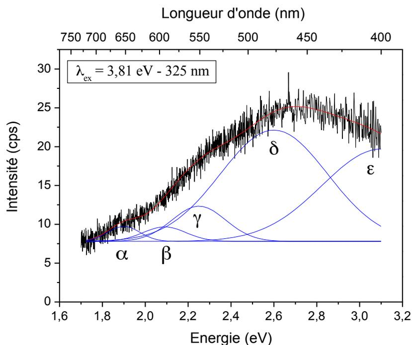
**Figure 108 : Spectre de photoluminescence obtenu pour la silice vierge sous excitation à 3,81 eV (325 nm).
