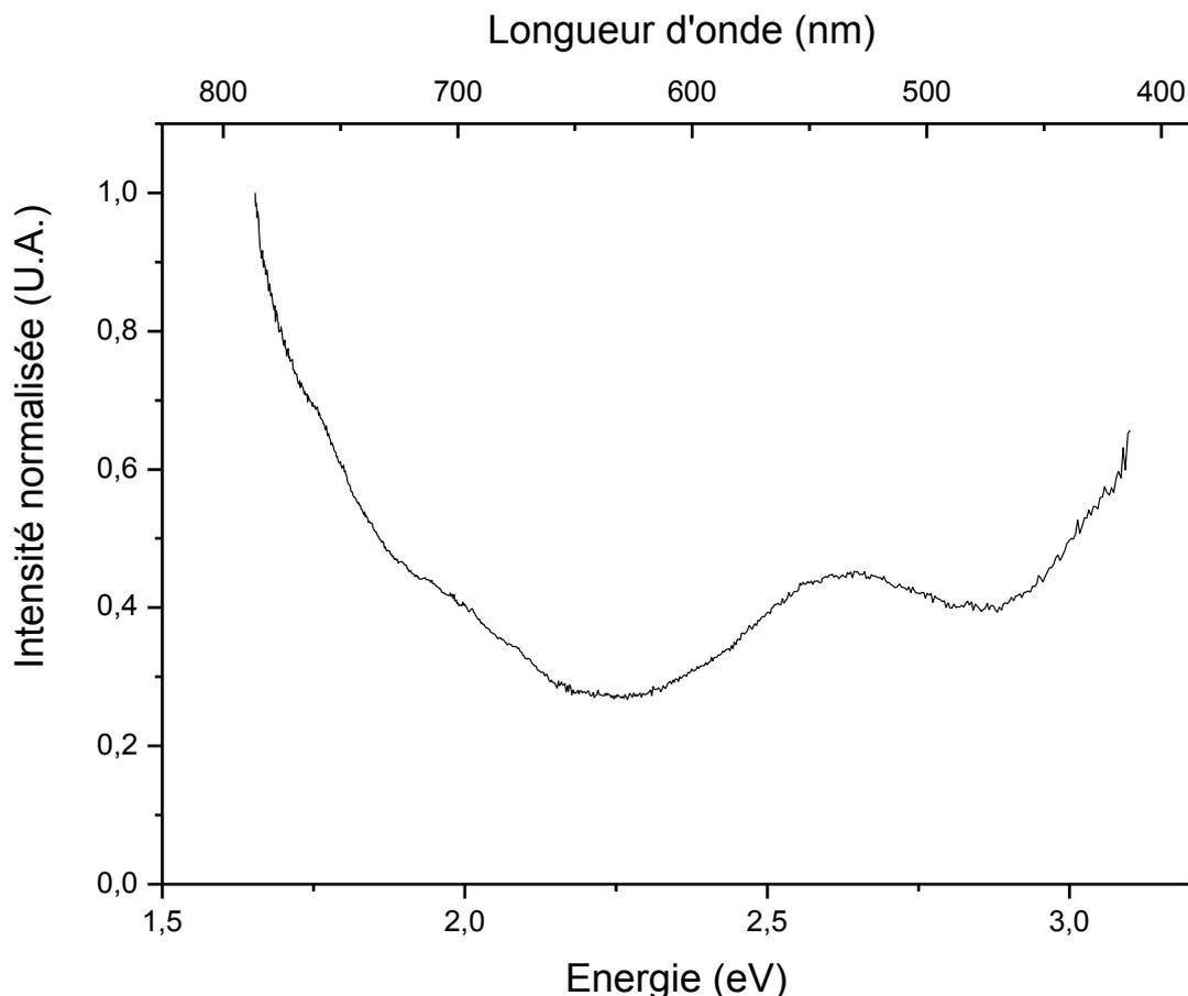
Figure 89 : Courbe de réponse de l'appareil obtenue à partir des verres dopés au  $\text{Cu}_2\text{O}$  et  $\text{Mn}^{2+}$ .
