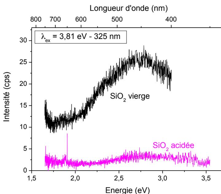
Figure 118 : Comparaison des spectres de luminescence entre une pièce acidée et une pièce non acidée.
