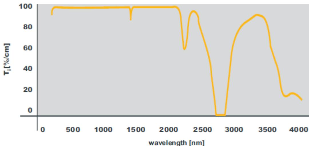
Figure 55 : Spectre de transmission de la silice CORNING 7980 [78].
