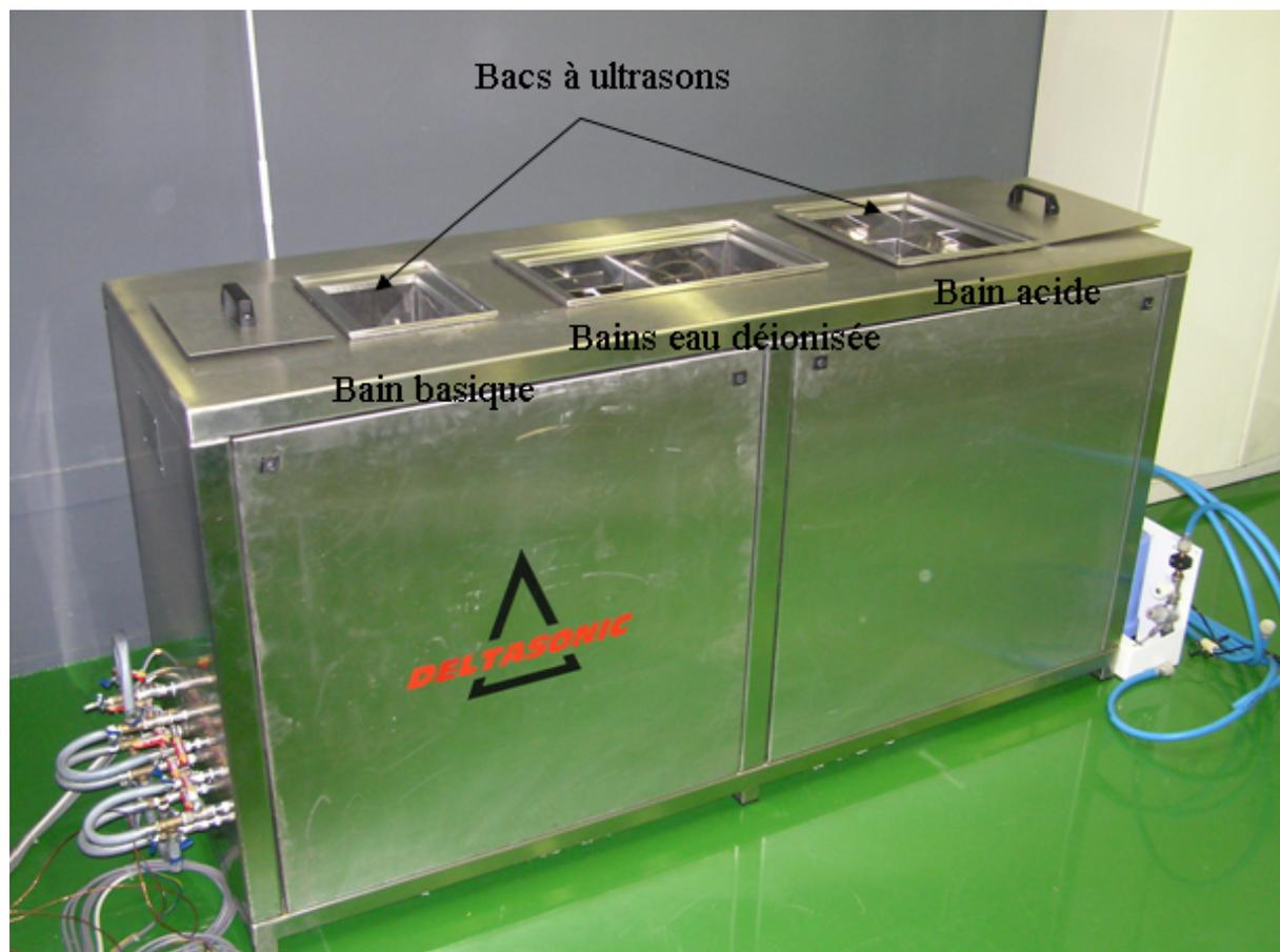
Figure 59 : Machine de nettoyage à ultra son.
