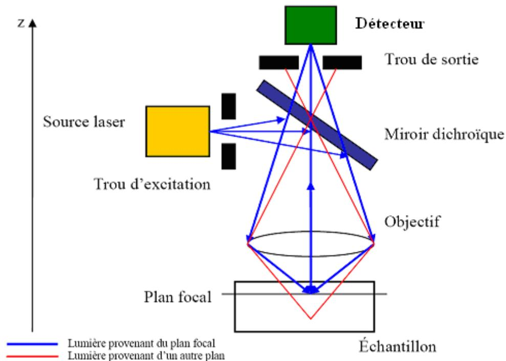
Figure 83 : Schéma de principe du microscope confocal.
