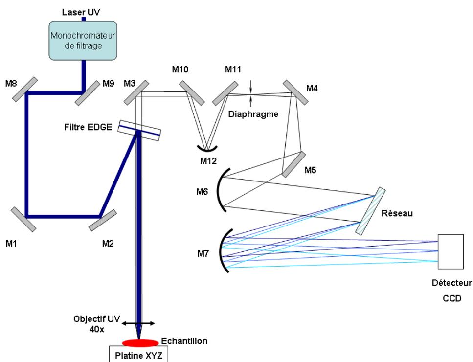
**Figure 86 : Schéma de principe du spectromètre de l'ISM. Les miroirs M1 à M12 permettent de transporter les faisceaux laser et le signal de luminescence. Le filtre EDGE est utilisé pour séparer le faisceau excitateur du signal de luminescence en rejetant le premier. Le réseau et le détecteur CCD permettent de définir la résolution du spectromètre.**
