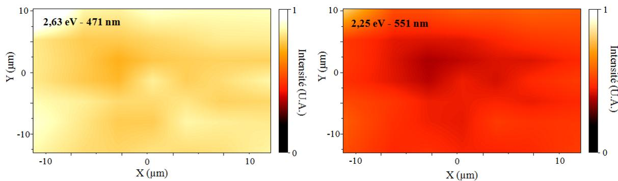
**Figure 96 : Cartographies de luminescence obtenues sur la silice vierge sous excitation à 3,81 eV.
