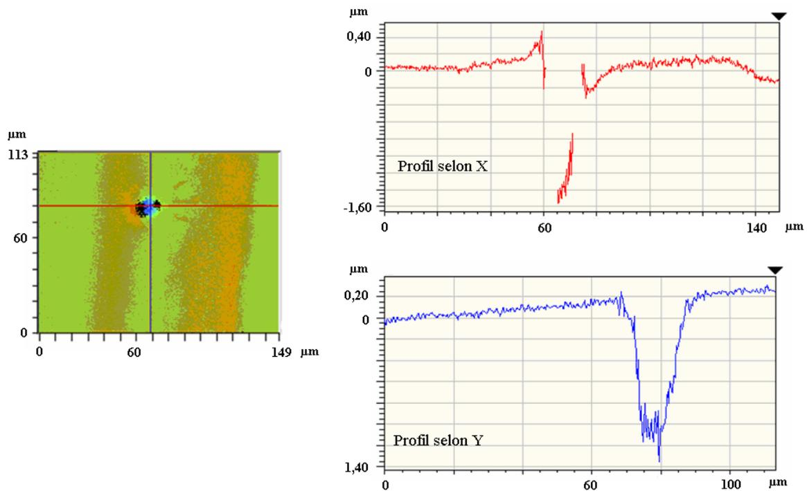
**Figure 71 : Vue en profilométrie optique d'une indentation.**
