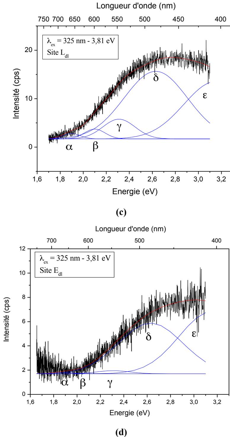
**Figure 101 : Spectres de photoluminescence pour le dommage laser sous excitation à 3,81 eV (325 nm) : (a) site  $I_{dl1}$ , (b) site  $I_{dl2}$ , (c) site  $L_{dl}$ , (d) site  $E_{dl}$ . En noir : données expérimentales, en rouge : ajustement global du signal, en bleu : Composantes gaussiennes du signal.**
