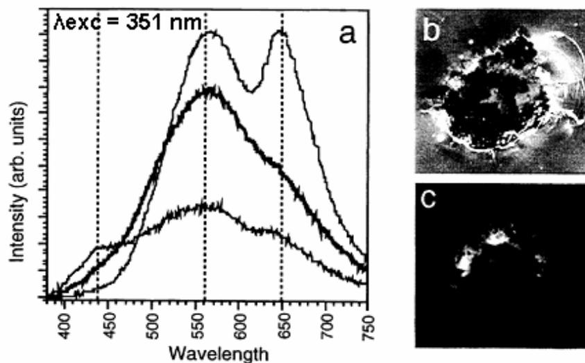
Figure 20 : a) Spectre d'émission de trois points différents provenant du même site d'endommagement sous excitation à 351 nm ; b) Site d'endommagement vu en lumière diffusée ; c) Image d'émission du même site endommagé [33].
