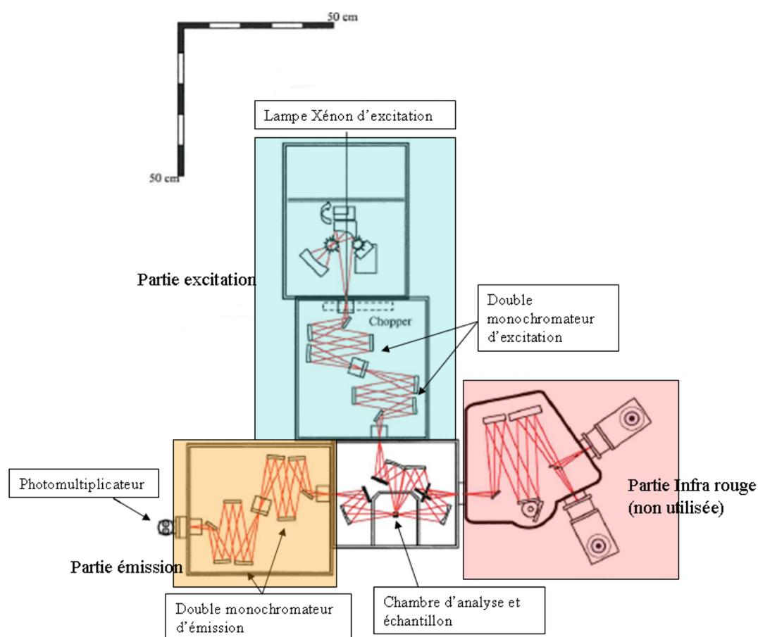
Figure 82 : Schéma de fonctionnement du spectrofluorimètre Fluorolog 3
