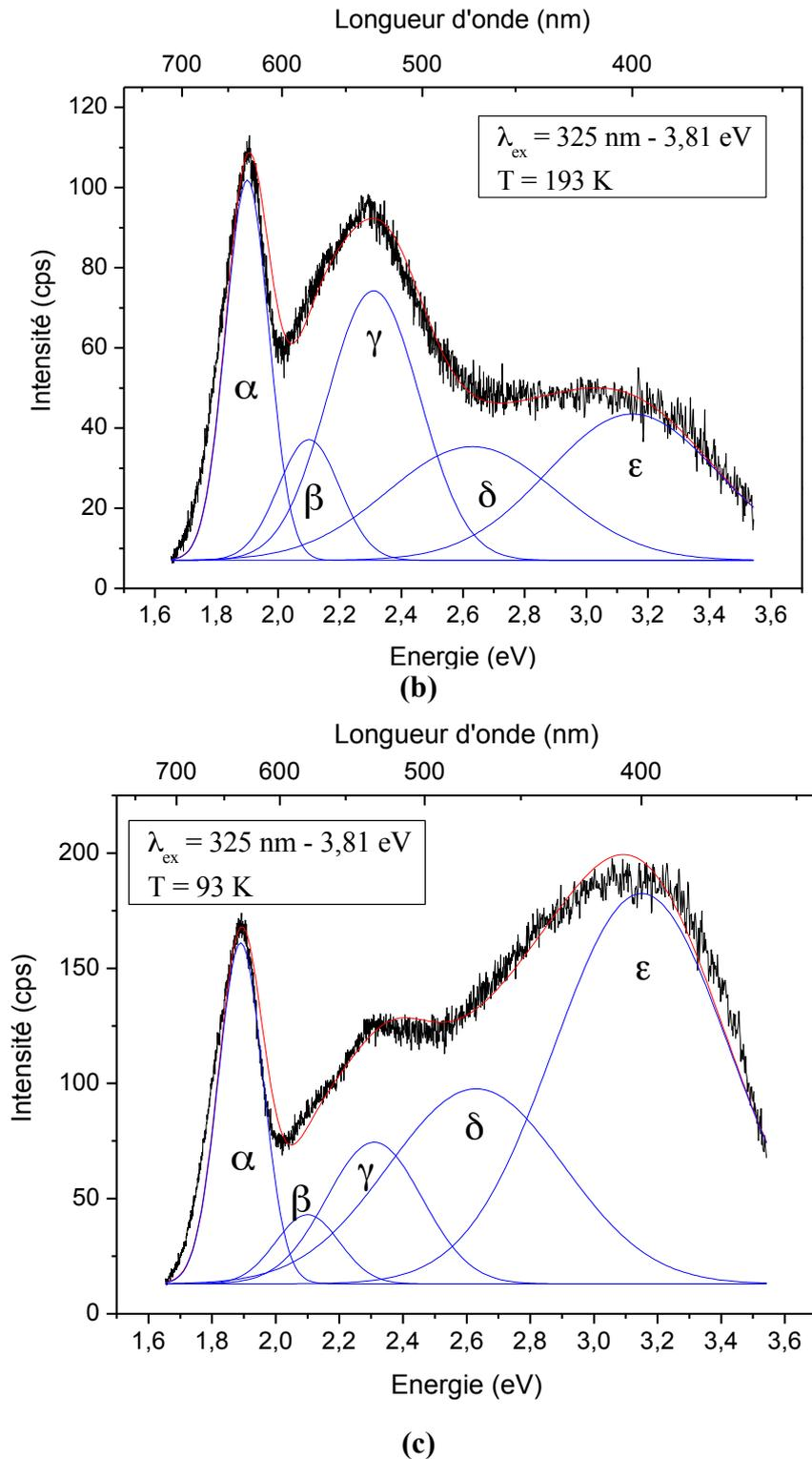
**Figure 113 : Spectres de photoluminescence pour le dommage laser sous excitation à 3,81 eV (325 nm). (a) 293 K. (b) 193 K. (c) 93 K. En noir : données expérimentales ; en rouge : ajustement global du signal ; en bleu : composantes gaussiennes du signal décomposé.**
