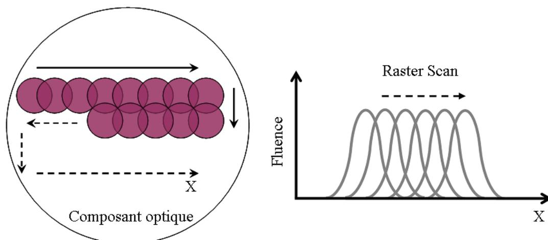
**Figure 76 : Représentation schématique de la procédure de « Raster Scan ». L'ensemble de la surface de l'échantillon est irradié par recouvrement du faisceau laser. La fluence totale reste la même au cours de la procédure.**
