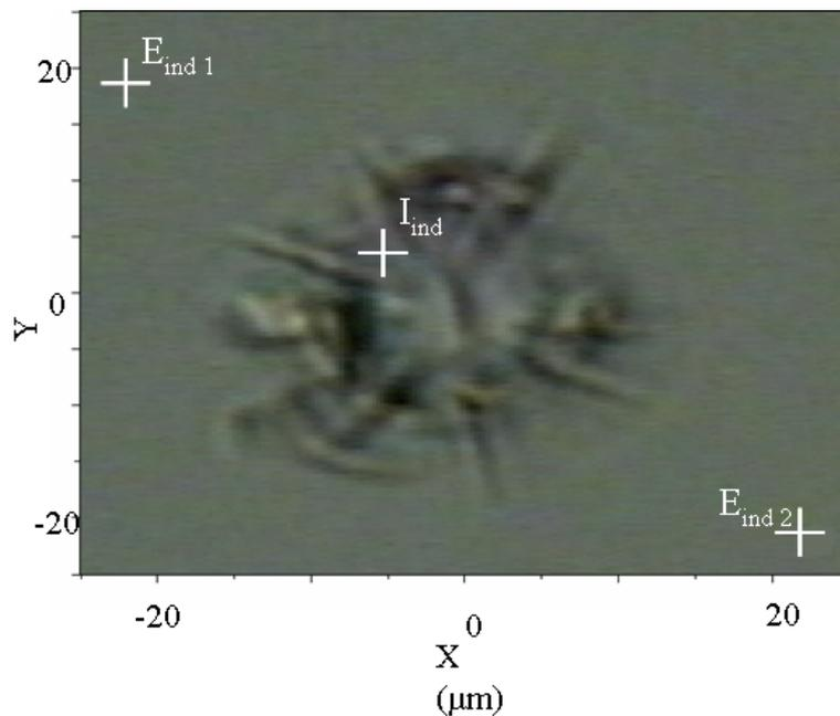
**Figure 97 : Image de microscopie en transmission pour une indentation.**
