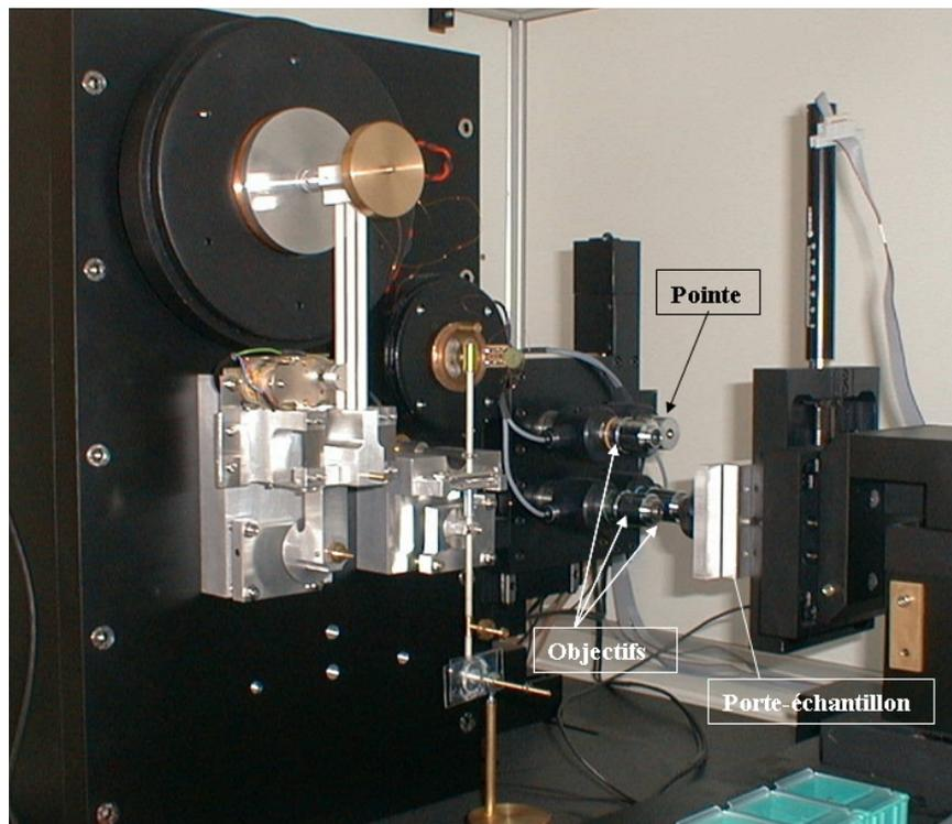
**Figure 63 : Photographie du nanoindentateur utilisé.**
