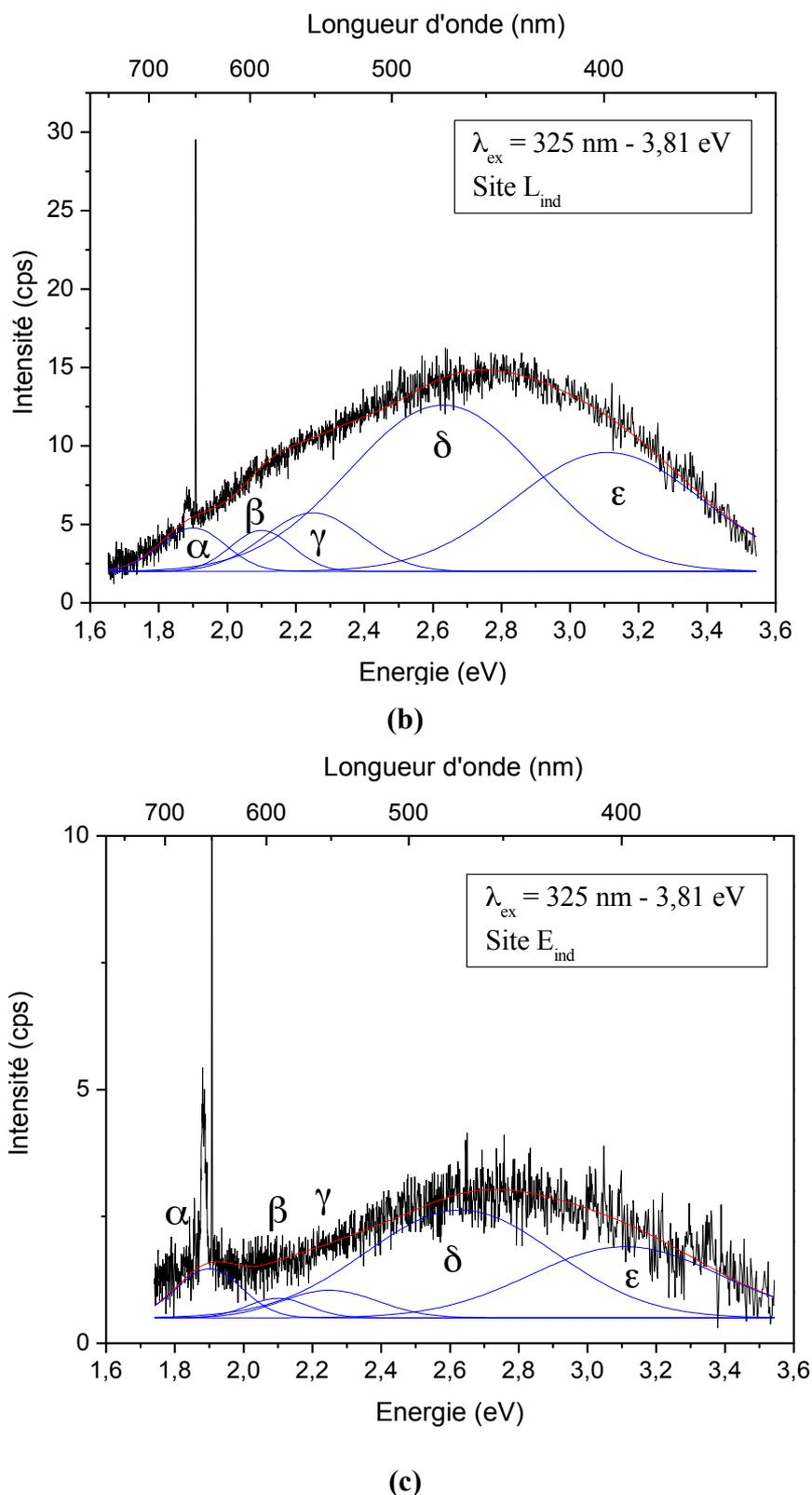
**Figure 120 : Spectres de photoluminescence pour les indentations acidées sous excitation à 3,81 eV (325 nm). (a) Site I<sub>ind</sub>. (b) Site L<sub>ind</sub>. (c) Site E<sub>ind</sub>. En noir : données expérimentales ; En rouge : ajustement global du signal ; En bleu : Composantes gaussiennes du signal.**
