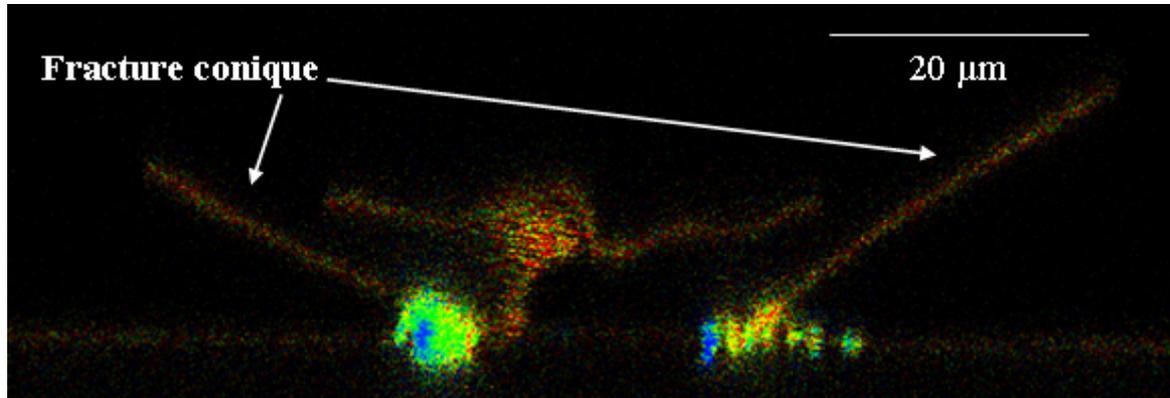
Figure 70 : Image en microscopie confocale de luminescence des fractures coniques obtenues pour une indentation sur le microscope confocal Picoquant Microtime 200.
