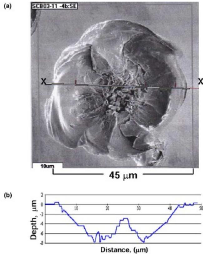
Figure 80 : (a) Image MEB d'un dommage. (b) Mesure de profilométrie sur ce dommage [94].
