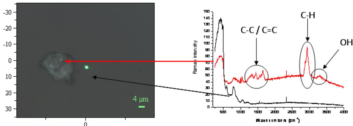
**Figure 61 : Image en microscopie optique et spectres de la particule et de la silice vierge autour de cette particule. Le point vert indique la position du laser lors de l'analyse de la silice vierge.**
