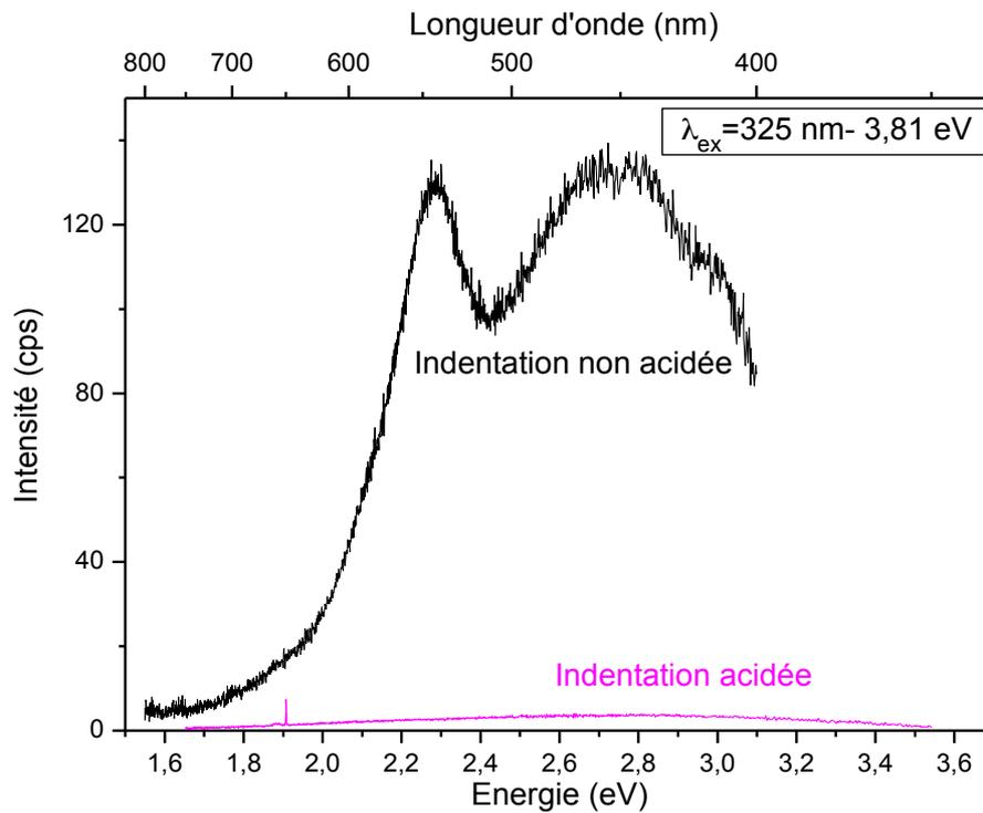
**Figure 121 : Comparaison des spectres de luminescence obtenus pour une indentation acidée et non acidée remis à niveau (puissance du laser 10  $\mu\text{W}$  et durée d'acquisition de 2 s). Le site étudié se situe à l'intérieur de l'indentation (site  $I_{ind}$ ).**
