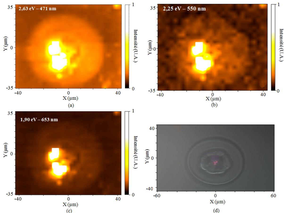
**Figure 122 : Cartographies de photoluminescence obtenues sur les indentations sous excitation à 3,81 eV (325 nm). (a) : cartographie pour l'émission à 2,75 eV. (b) : cartographie pour l'émission à 2,25 eV. (c) : cartographie pour l'émission à 1,89 eV. (d) : image de microscopie en transmission pour l'indentation acidée.**
