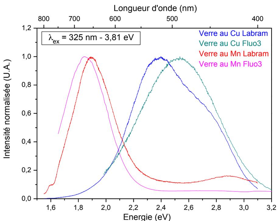
Figure 88 : Comparaison des spectres d'émission des verres dopés au Cu<sub>2</sub>O et au Mn<sup>2+</sup> sous excitation à 325 nm.
