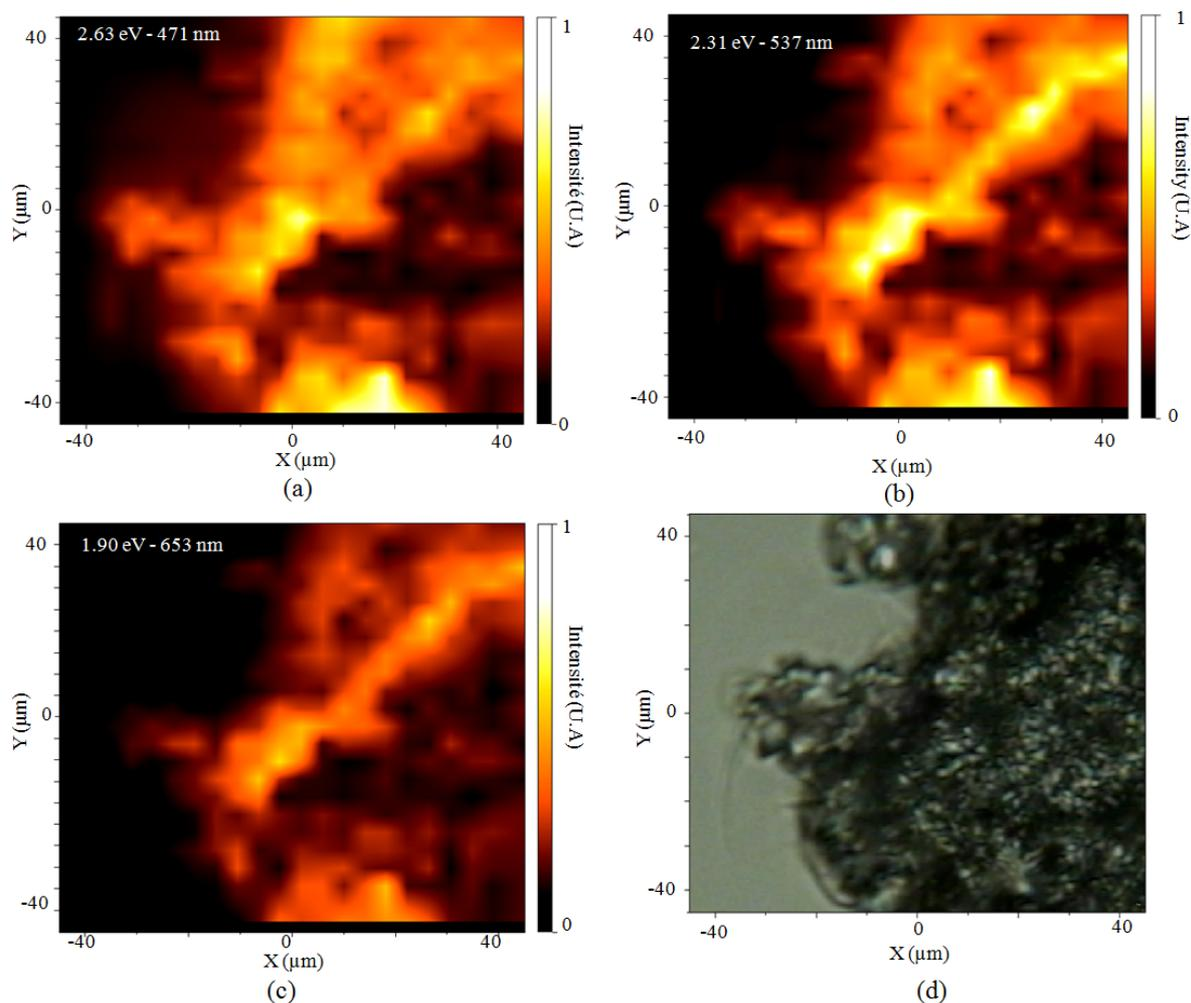
**Figure 103 : Cartographies de photoluminescence obtenues sur le dommage laser sous excitation à 3,82 eV (325 nm) : (a) cartographie pour l'émission à 2,25 eV, (b) cartographie pour l'émission à 2,75 eV, (c) cartographie pour l'émission à 1,89 eV, (d) image de microscopie en transmission pour l'indentation.**
