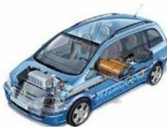
Figure I.19 : Véhicule hydrogen3 qui utilise un moteur à combustion interne. Le réservoir à hydrogène (stockage liquide) est représenté en orange sur la photo.
