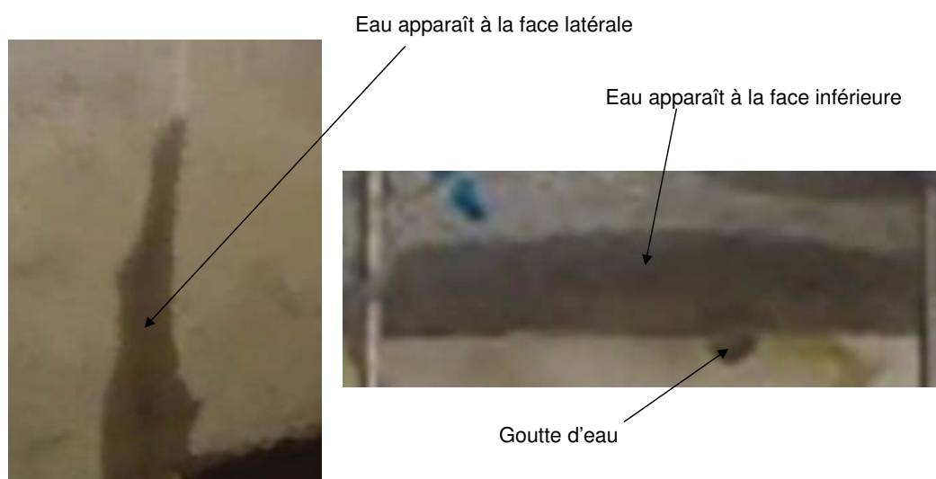
Figure 5.17 — Apparition de l'eau à une face latérale et puis à la face inférieure au cours de l'essai.
