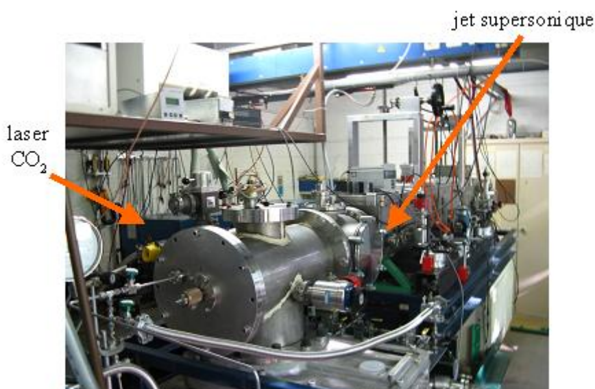
Photo 1 : Vue d'ensemble du spectromètre avec le jet supersonique et le laser CO 2 .
