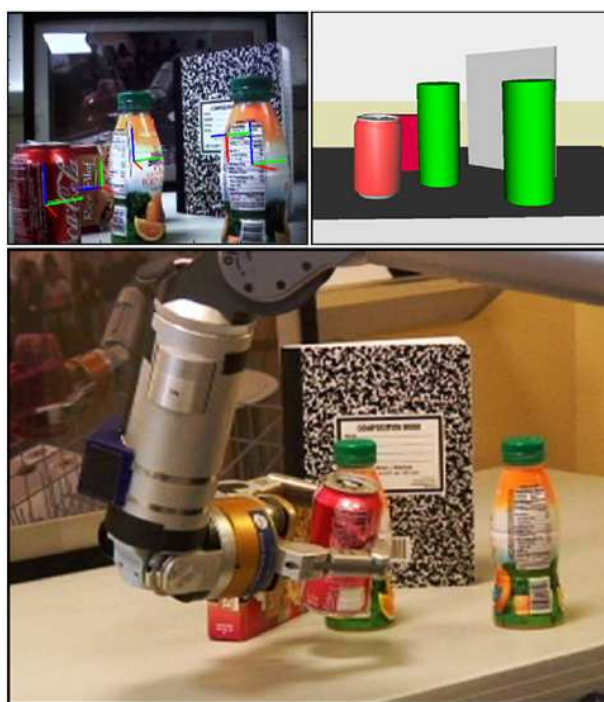
FIGURE 1.17 – Suivi d'objets sans marqueur par caméra [CBSSF09]
