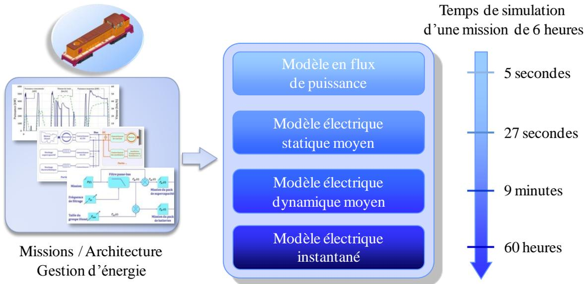
**Figure 1.3.** Temps de simulation d'une mission de durée 6 heures avec les différents types de modèles utiles à la conception d'une locomotive hybride
