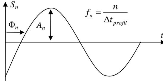
**Figure 3.2.** Paramètres d'un motif de rang  $n$  :  $A_n$ ,  $f_n$  et  $\Phi_n$
