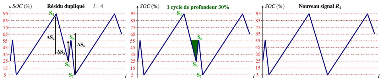
Figure C.10. Extraction des cycles du résidu : première itération
