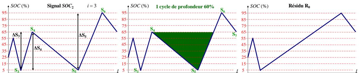
Figure C.8. Troisième itération : extraction d'un cycle de profondeur 60%
