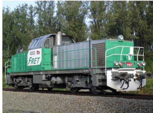
La locomotive BB460000 est une locomotive diesel dotée d'un groupe Diesel de 1 MW. Nous disposons de 27 missions effectuées sur la zone FRET de SOTTEVILLE et LE HAVRE. La [Figure A.4](#) donne quelques missions de la locomotive BB460000.
