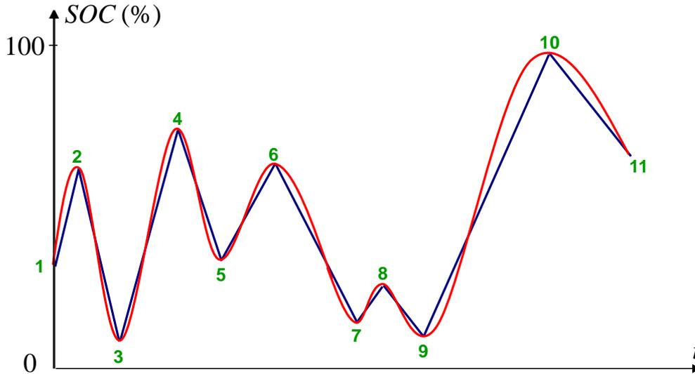
**Figure C.2.** *Extraction des extremums de la courbe  $SOC(t)$*
