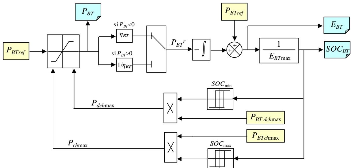
Figure 4.4. Modèle en flux de puissance des batteries
