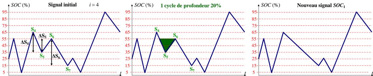
Figure C.6. Première itération : extraction d'un cycle de profondeur 20%
