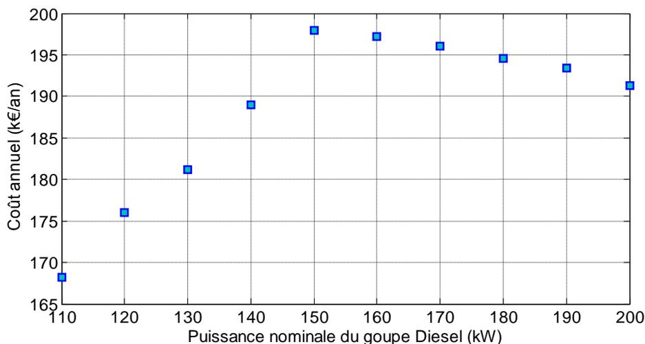
**Figure F.3.** *Évolution du coût de possession annuel de la locomotive en fonction de la puissance nominale du groupe Diesel*
