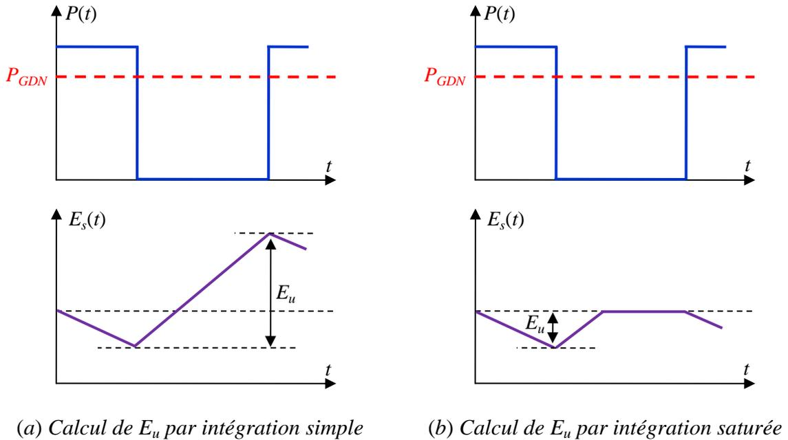
**Figure 1.25.** Illustration du calcul de l'énergie utile  $E_u$
