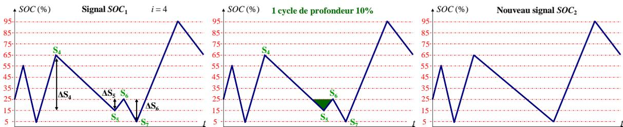
Figure C.7. Deuxième itération : extraction d'un cycle de profondeur 10%
