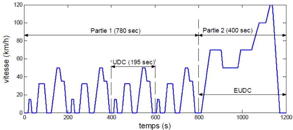
**Figure 1.12.** Nouveaux cycles Européen de conduite mixte NEDC
