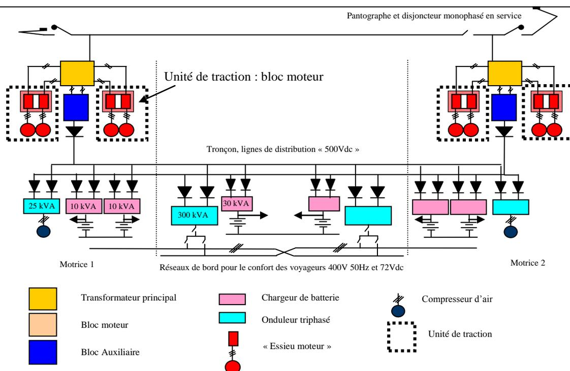
**Figure B.3.** Distribution énergétique du TGV POS
