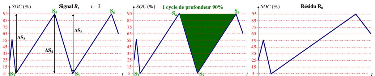
Figure C.11. Extraction des cycles du résidu : deuxième itération
