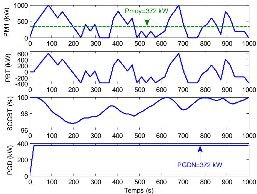
**Figure 4.10.** Résultats de simulation de la locomotive hybride avec la mission  $M_1$
