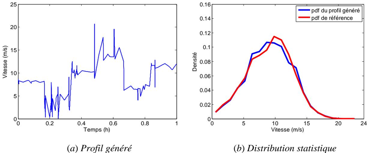
**Figure 3.24.** Résultat du processus de synthèse pour une durée de 1 heure
