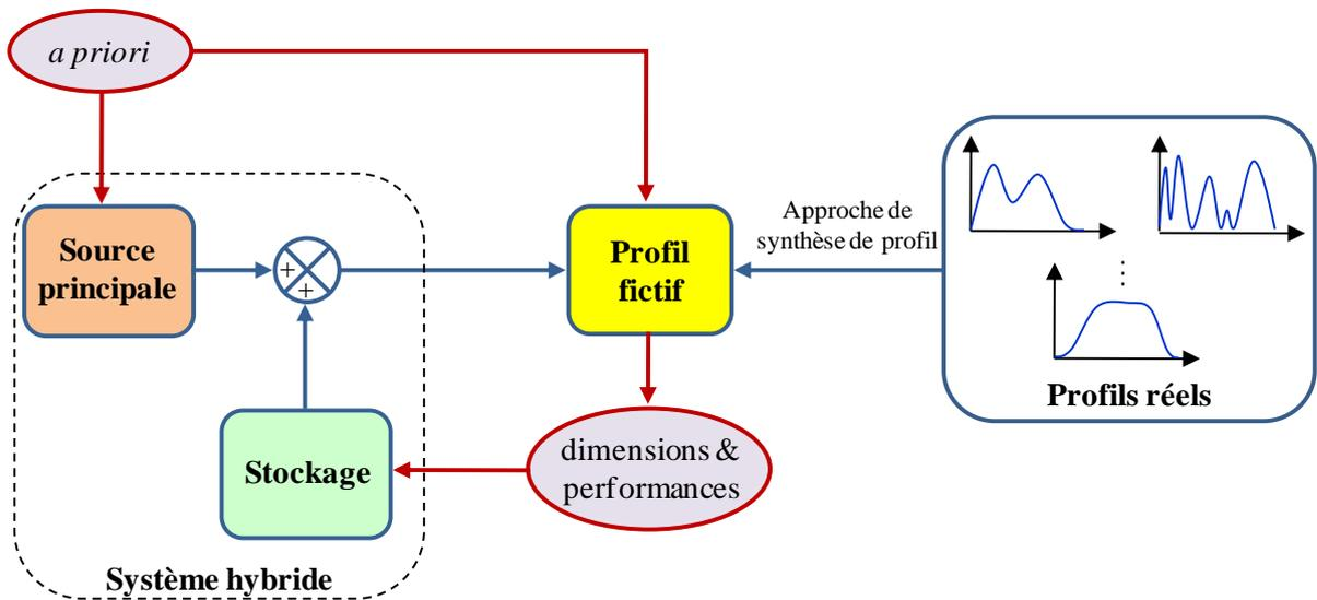
Figure 1.19. Architecture d'un système hybride avec stockage
