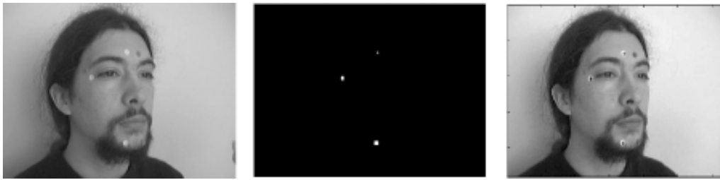
Figure 4. Détection des marqueurs jaunes (de gauche à droite) : image d'origine, image binaire obtenue avec le filtrage de couleurs sur les composants Teinte et Saturation et la localisation des marqueurs.
