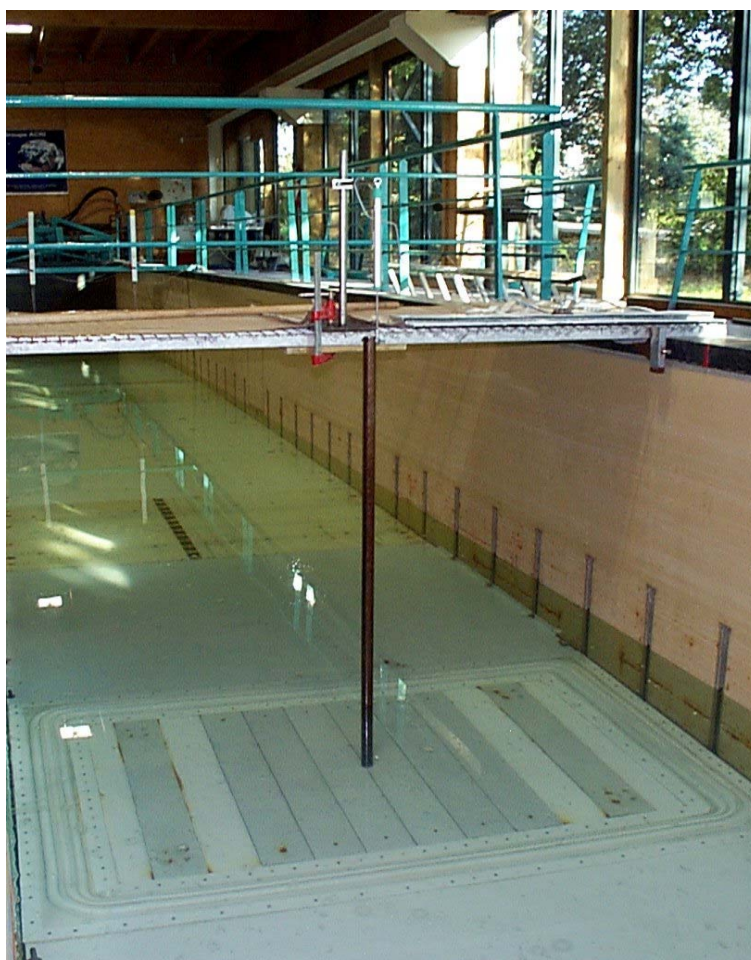
FIG V.16 – Photo du dispositif de récupération de l'énergie de la houle installé dans le canal à houle d'ACRI IN prise depuis le mur réfléchissant
