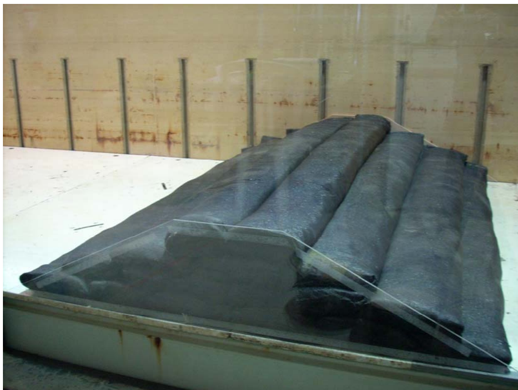
FIG VI.15 – Photo du récif artificiel immergé en géotextile dans le canal
