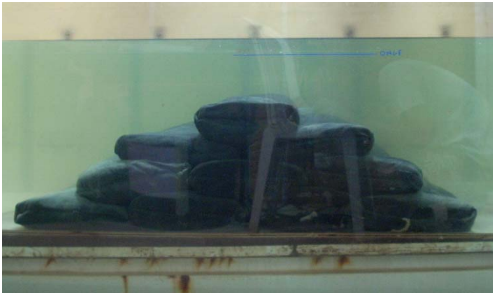
FIG VI.33 – Photo du récif de dimensions réduites dans le canal à houle pour une surcote de +0.9m NGF
