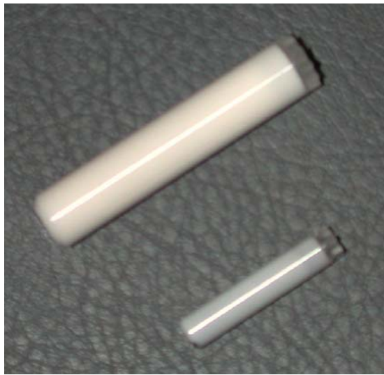
Figure II- 21 : Rotors de 4 et 7 mm de diamètre respectivement utilisés pour l'acquisition des spectres d'aluminium et de silicium
