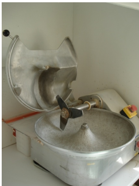
Figure II- 13 : Malaxeur à couteaux utilisé pour malaxer le mélange matériau humide – chaux vive.
