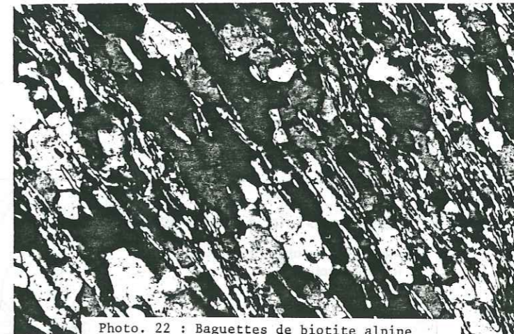
Photo. 22 : Baguettes de biotite alpine développées dans la direction de flux des ultra-mylonites de la bordure nord-occidentale du Mont-Blanc. (1.m. en section \lambda_1 \lambda_3 ; nicols croisés)
