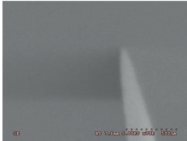
Figure 4.5 – Image MEB d’une pointe de silice pour l’AFM obtenue par étirage d’une fibre optique. Le rayon de courbure à l’apex est de l’ordre de 50 nm.
