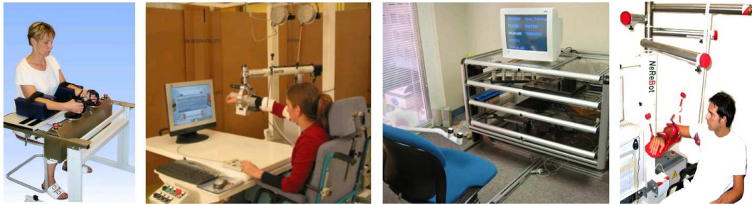
FIGURE 1.12 – Stations de travail et robots à câbles en rééducation. De gauche à droite : Bi-Manu-Track, Gentle/s, Autocite, Nerebot
