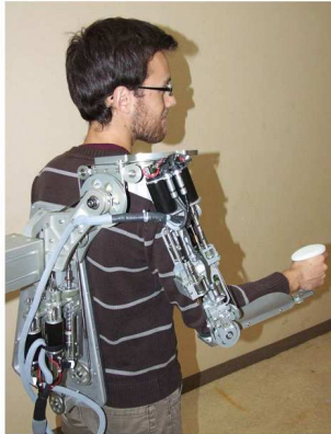
FIGURE 2.1 – Vue d'ABLE sans sa coque de protection
