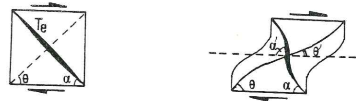
Fig. 88 : Variations progressives des angles repères \alpha' et \theta' dans le cas de déformation inhomogène. (Cas d'un plan de cisaillement unique).
