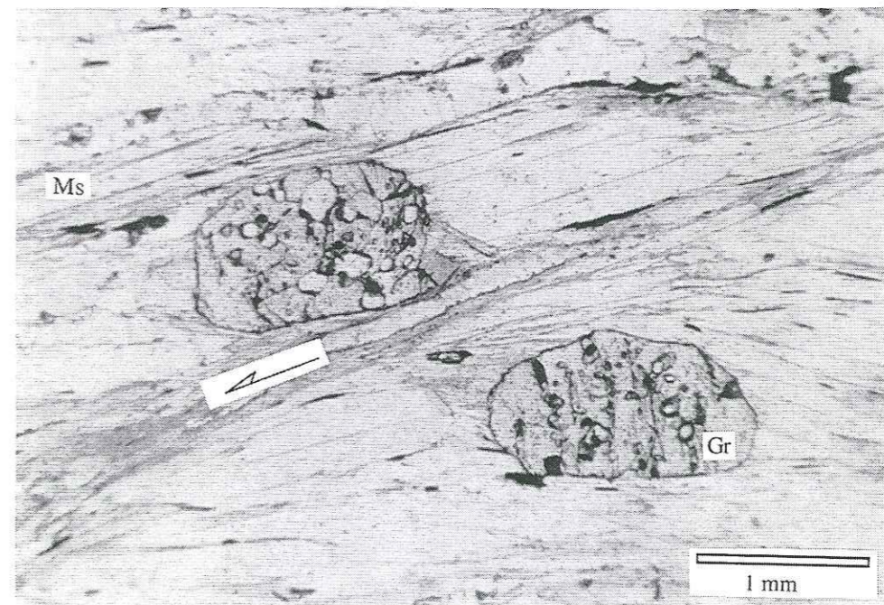
Planche 10-photo 20 : Détermination du sens de cisaillement dans des paragneiss à deux micas et grenat. Lame mince (lumière naturelle) d'un échantillon provenant de la base de nappe, le long de la vallée de la Phalangu.
