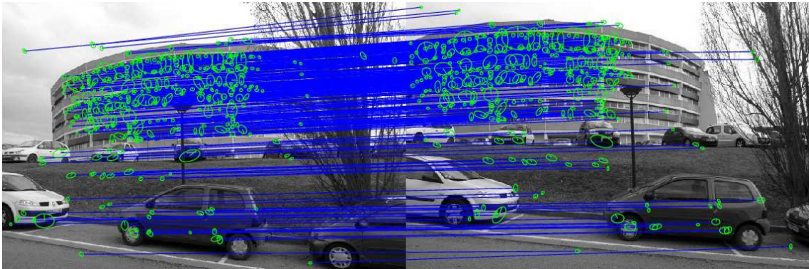
FIGURE 6.9 – Bâtiment du second-cycle : I-ASIFT permet ici de couvrir la scène d'appariements sur une grande profondeur. Il faut noter cependant que quelques points sont incorrectement mis en correspondance, en particulier ceux sur l'arbre à droite et ceux dans le ciel. Cela s'explique car ceux-ci sont cohérents avec une homographie locale, ainsi qu'avec le mouvement global donné par la géométrie épipolaire.
