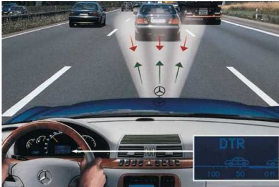
FIGURE 1.1 – Exemple d’alerte pour le conducteur du risque de collision
