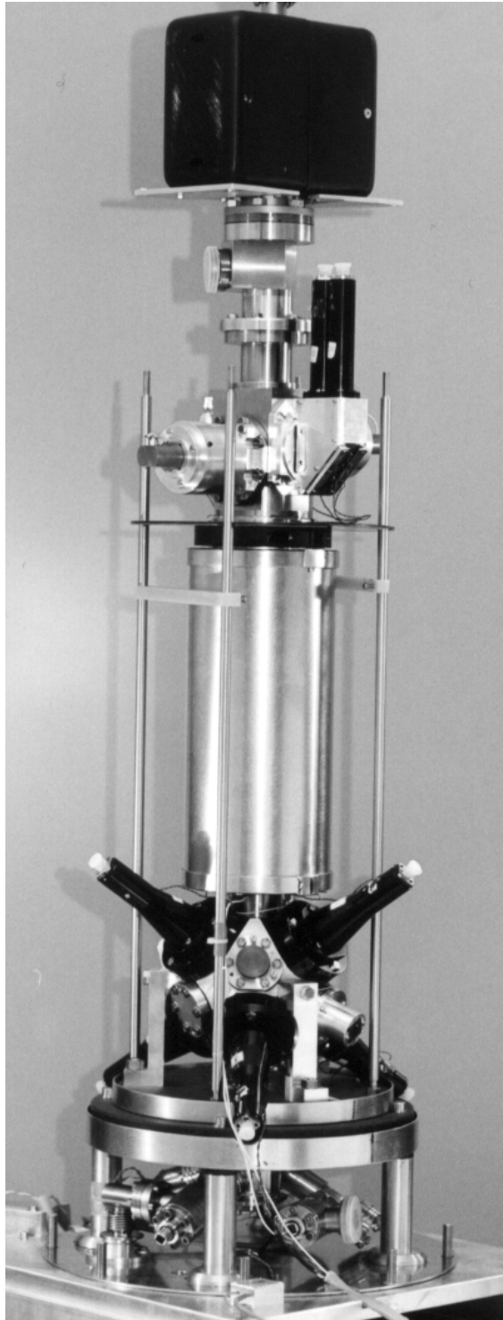
Fig. 6-3: Photographie de l'enceinte à vide. Nous apercevons de bas en haut : la zone de refroidissement laser, la zone d'interaction micro-onde, la zone de détection optique et la pompe à vide principale.
