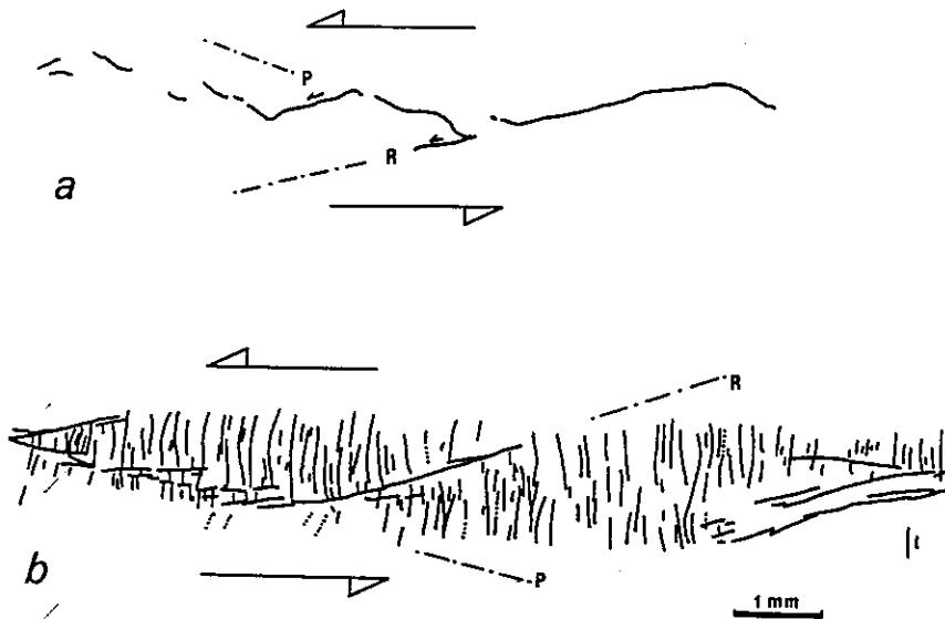
Fig. 120 - Mise en évidence de fractures P symétriques des R par rapport à la direction de cisaillement. (a) : dans une plaque de calcaire soumise à un confinement de 50 MPa et pour un déplacement relatif de 0,14 cm (d'après Bartlett et al. 1981). (b) : dans une kaolonite sous contrainte normale de 2,2 \times 10^{-1} MPa et pour un déplacement relatif de 0,8 cm (d'après Tchalenko 1970).
