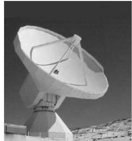
Figure 2.5 – Antenne de 30\text{ m} de l'IRAM (Pico Veleta, Espagne). La forme et la disposition de ses réflecteurs sont de type Cassegrain
