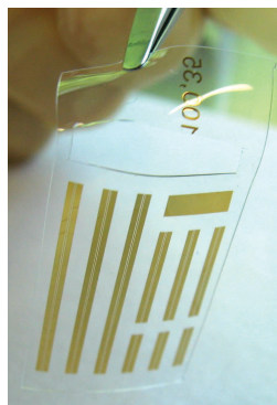
FIGURE 2.40 – Prototype de lignes CPW réalisées avec le procédé n°2
