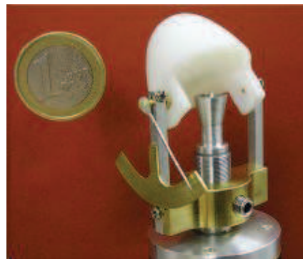
FIGURE 1.12 – Antenne à lentille développée par Costa et al. [73]
