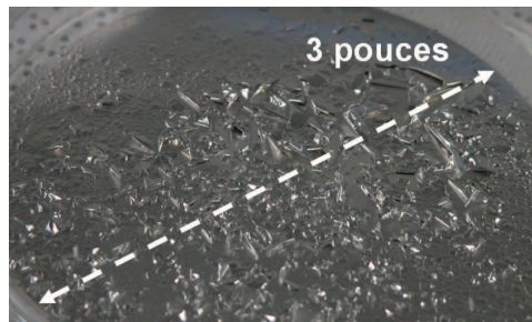
FIGURE 2.31 – Pulvérisation d'aluminium sur PDMS : la métallisation présente fissures et décollements
