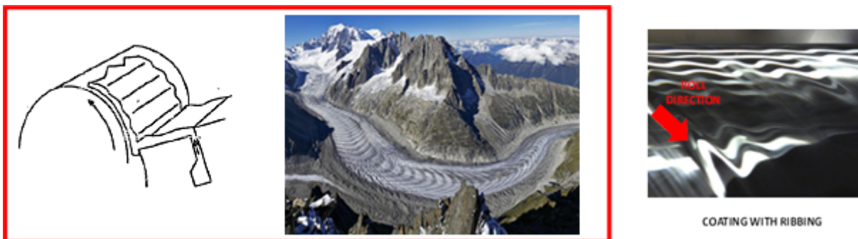
Figure 14: Différents défauts pouvant apparaître sur un plan incliné (« barring » à gauche et « ribbing » à droite).
