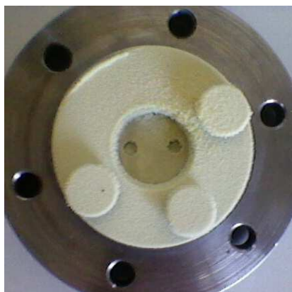
Figure III-11 - Visualisation de la lécithine micronisée dans le fond de l'autoclave
