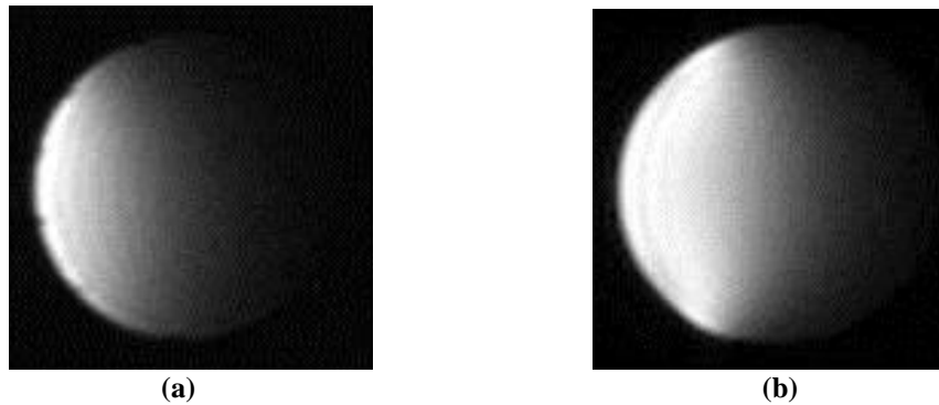
Figure I-18 – Images de fantômes à 2,35 T. (a) Obtenue avec un RMLT plat. (b) Obtenue avec un RMLT sur support souple adapté à la forme du fantôme.
