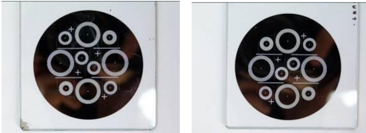
Figure II-7 – Masques de lithographie utilisés pour la fabrication de résonateurs en cuivre sur saphir. Les paramètres géométriques des différents résonateurs ont été calculés en implémentant la formule de la condition de résonance dans le logiciel Matlab. On a ainsi pu les déterminer automatiquement pour soit une fréquence de résonance et une permittivité du substrat fixées, soit une fréquence de résonance et une hauteur du substrat fixées.
