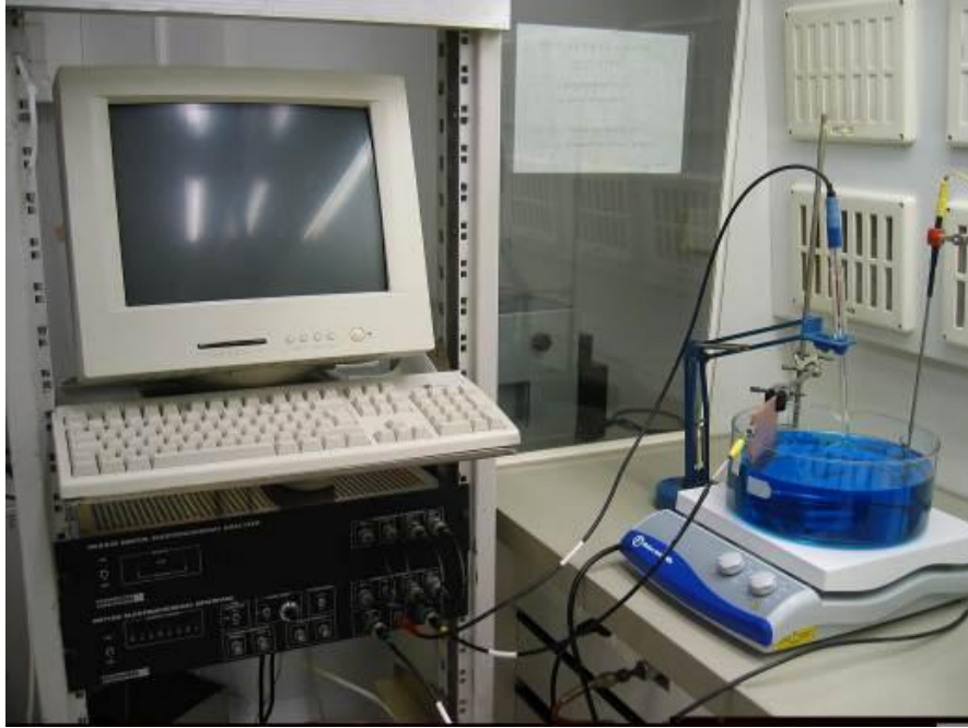
Figure II-5 - Photographie du dispositif expérimental du dépôt électrolytique.
