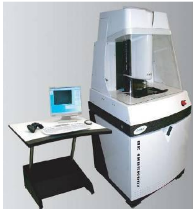
Figure Annexe E-4 - Profilomètre vibromètre interférométrique Zoomsurf 3D, commercialisé par la société FOGALE Nanotech
