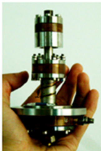
FIG. 1.14 – Prototype de pulse tube optimisé à 120 Hz [14].
