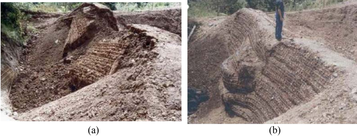
Figure 1-7 : Etat du remblai après impact. Ouvrage non renforcé (a) et ouvrage renforcé par nappes de géogrilles (b) [Peila et al. 2007].
