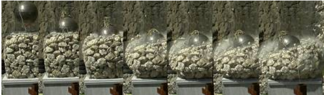
Figure A 15 : Décomposition de l'essai d'impact sur une cellule de gabion « pierre » d'un mètre cube [Lambert 2007].
