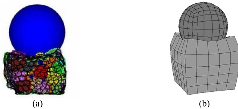
Figure 1-31 : Modèles discret [Bertrand 2007] et continu [Breugnot 2007] de l'impact d'une sphère sur une cellule remplie de géomatériaux.
