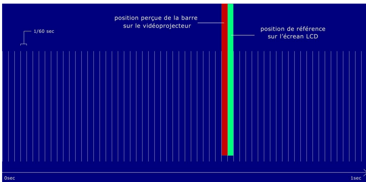
Figure 73 - Représentation des mesures de latence effectuée sur le vidéoprojecteur et l'écran.
