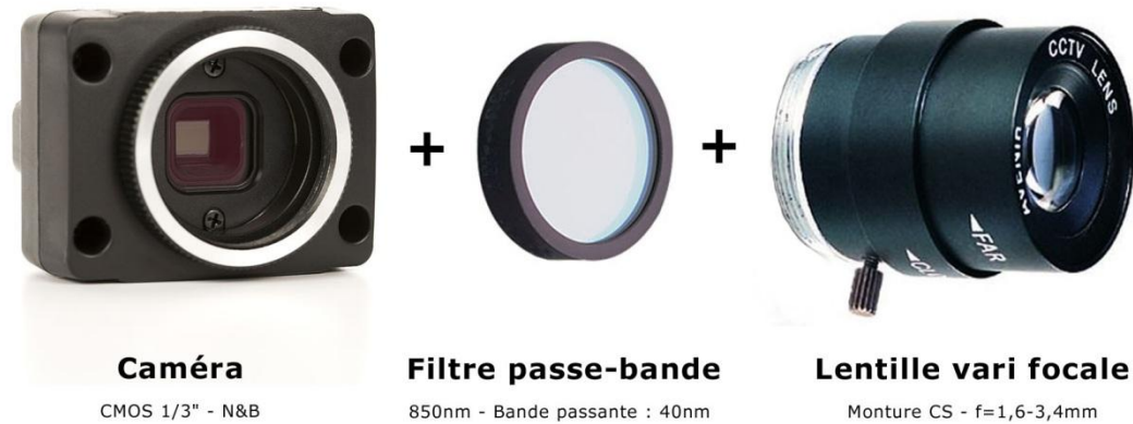
Figure 64 - Configuration du système de capture optique.
