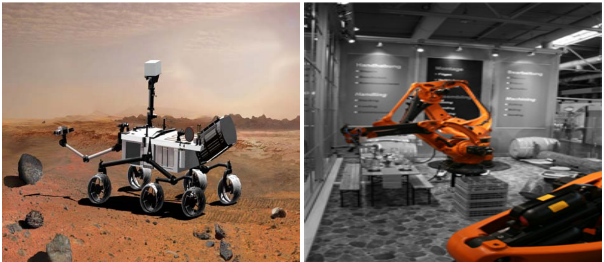
Figure 1: Le robot rover qui va naviguer sur Mars; il crée son combustible à partir de l'atmosphère martienne et progresse par déplacements d'un km par jour (à gauche). Bras manipulateur à poste fixe utilisé dans l'industrie (à droite)
