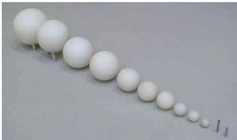
Figure 2.1 : De gauche à droite, un jeu de 10 sphères de polyéthylène de diamètre de 2 à 15 pouces, un capuchon en cadmium et le détecteur nu [Aroua, 1992a].
