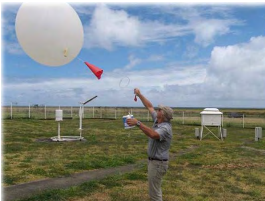
Figure 3-3: Lâcher d'un radiosondage à la station météorologique de l'aéroport de Gillot (Saint Denis).
