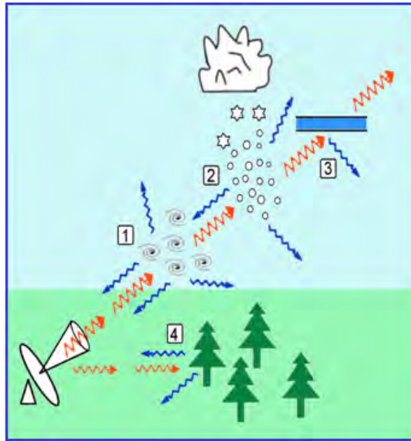
Figure 4-2: Les différents types de source d'échos radar.
