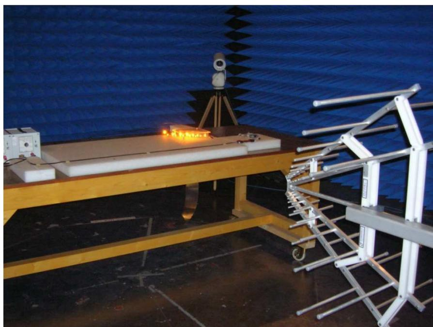
FIG. 5.60. Setup des mesures d'immunité au champ rayonné du phare à LEDs en chambre semi-anechoïque de l'IRSEEM
