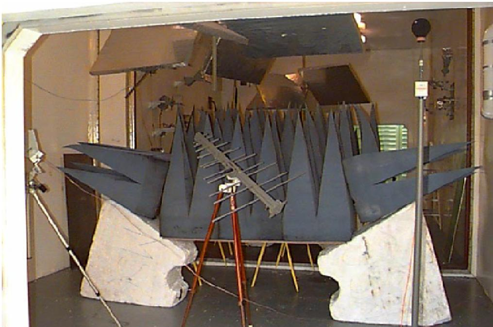
FIG. 4.1 Distribution des absorbants pour l'essai relatif aux effets de charge [5]
