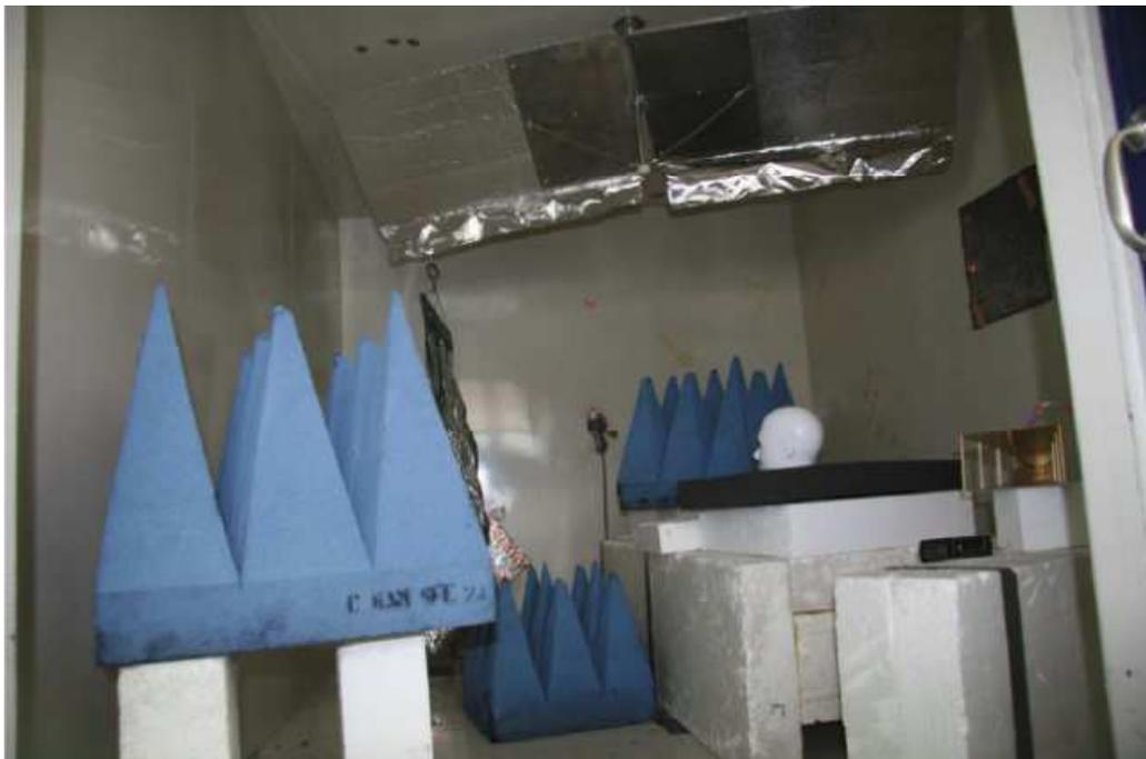
**FIG. 2.5.** Simulation d'environnements de propagation spécifiques en *CRBM* (Holloway, NIST)
