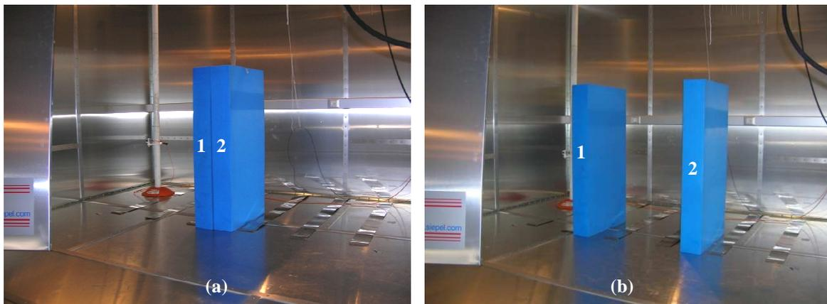
FIG. 4.46. Variation de la distribution et l'orientation de la charge avec deux absorbants ((a) config.2 et (b) config.3)
