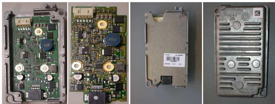
FIG. 5.50. Circuit Driver des LEDs avec son capot métallique
