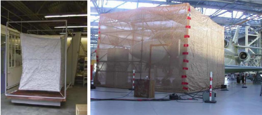
FIG. 2.4. Chambre réverbérante intrinsèque à parois vibrantes (VIRC) [59]
