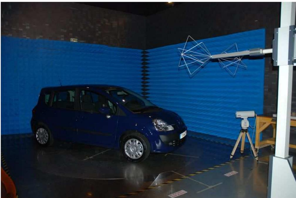
FIG. 3.1. Tests CEM sur véhicule en chambre semi-anéchoïque de l'IRSEEM
