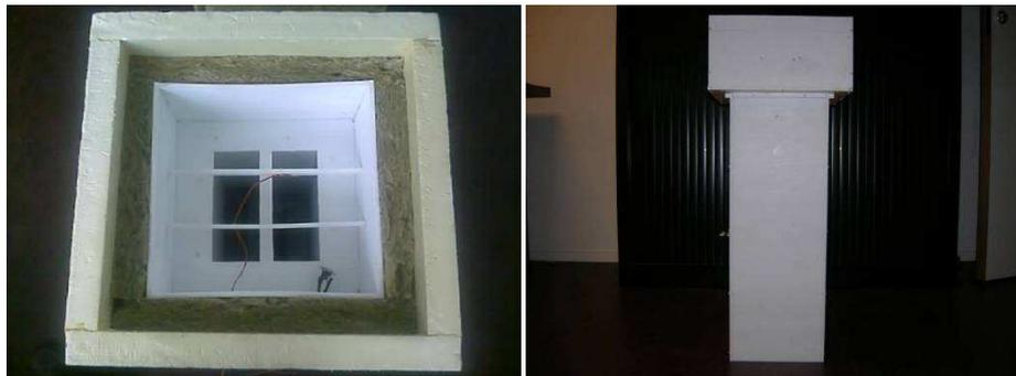
FIG. 5.16. Enceinte thermo-régulée (prototype n°2) en phase de réalisation
