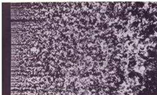
Fig. 2.7- Turbulence homogène générée par une grille, Re_M = 1500 et M = 2.54 cm, Van Dyke (1997).
