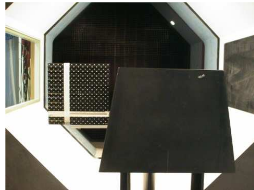
Fig. 2.26- Etalonnage des caméras pour un essai S-PIV, la mire est positionnée à 250mm du nez ( L2 ).
