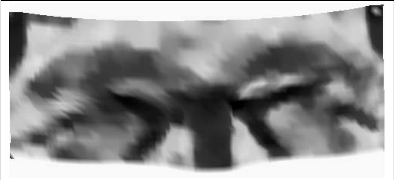
Figure 5.1. Représentations de la plus grande courbure principale en chaque point de la surface. Les régions sombres correspondent aux points de forte courbure et les régions claires aux points de faible courbure. Cette information géométrique permet de caractériser certaines parties du visage telles que les arêtes du nez et les sourcils.
