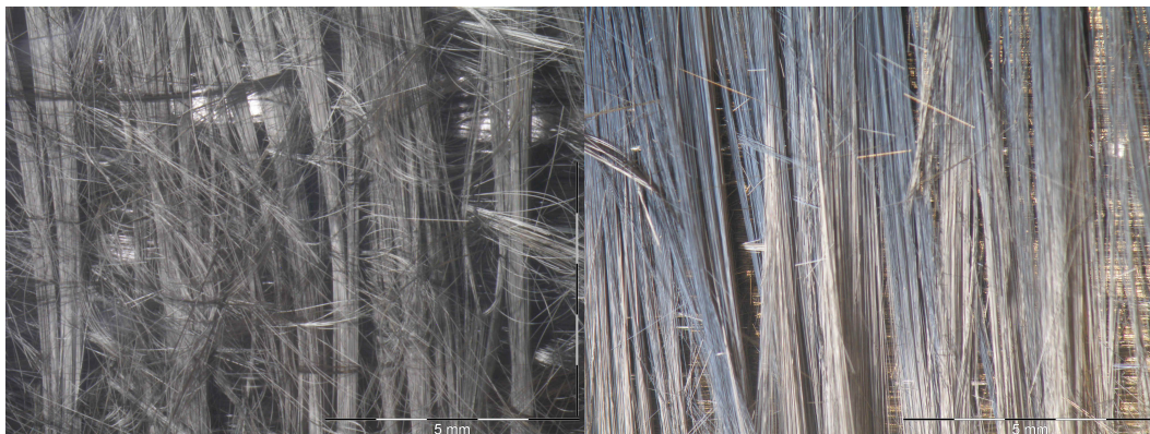
FIGURE IV.61 – Photos du support de référence « simple aiguilletage » de qualité d'aiguilletage différente - à gauche : bon aiguilletage - à droite : mauvais aiguilletage
