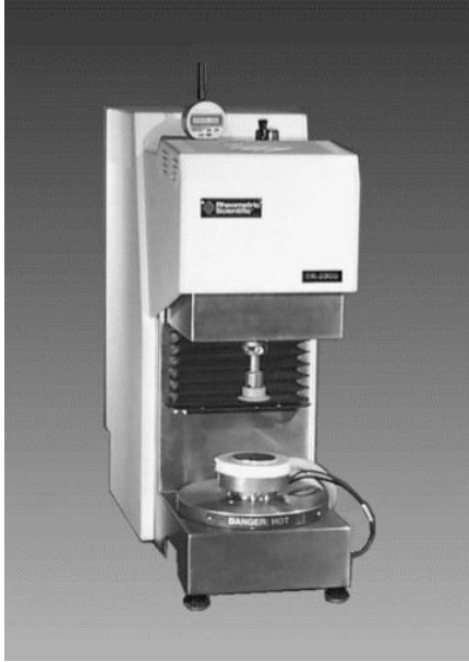
FIG. 1.6 – Le rhéomètre est un dispositif permettant, par application de contraintes sinusoïdales, la mesure de paramètres mécaniques dynamiques de tissus mous.
