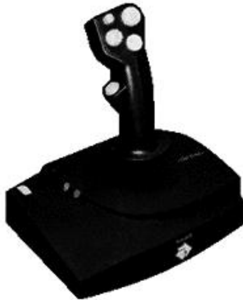
FIG. D.2 – Le PowerStick, joystick à retour de force développé par la société Exos.
