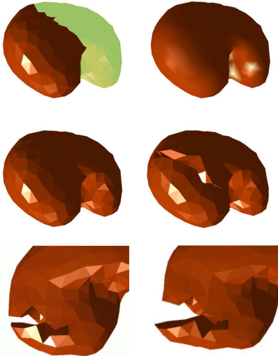
FIG. 6.9 – Déformation et découpe d'un modèle hybride. Ici les deux sous-maillages ont été réalisés sans se baser sur les informations d'une image volumique. Le maillage initial a simplement été découpé en deux parties de taille à peu près identique.
