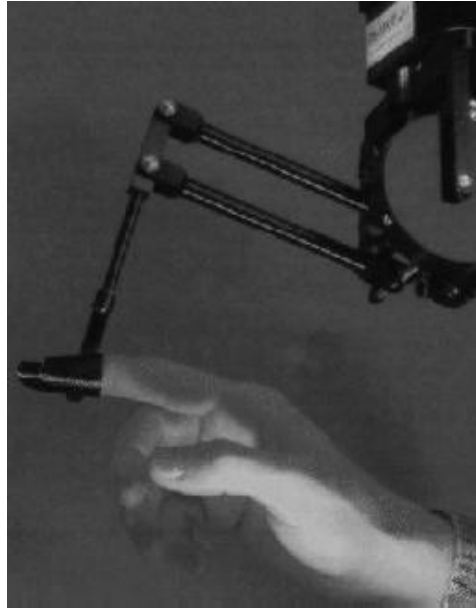
FIG. D.8 – Système à retour d'effort PHANTOM, développé au MIT.
