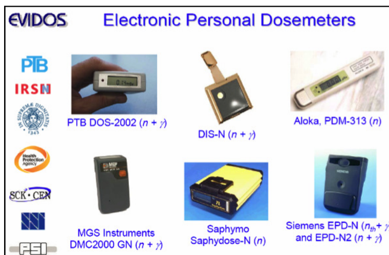
FIGURE 1.22 – Quelques dosimètres opérationnels neutrons testés lors de l'enquête EVIDOS.
