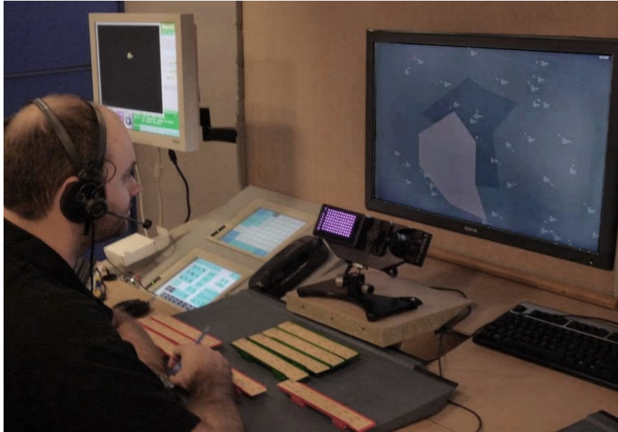
FIGURE 11: L'environnement de simulation incluant la caméra d'enregistrement à distance des mouvements oculaires
