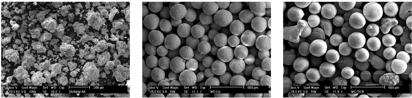
Figure 2.3 – Images MEB des poudres étudiées dans le cadre du programme européen de recherche Brite Euram « Modelling of Cold Compaction » ( MC^2 ) : poudre de fer Distaloy AE à gauche suivie successivement des poudres de carbure de tungstène WC-Co puis WC-TiCN.
