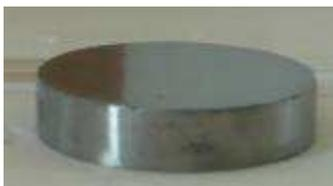
*Figure D-11 : Photographie de la cible,  $d= 26$  mm et  $e= 5,9$  mm,  $\text{Ge}_2\text{Sb}_2\text{Te}_5$  après nettoyage et polissage.*
