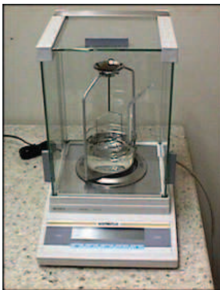
FIGURE 4.16: Appareil utilisé pour les mesures de densité - avec la permission de la société Roxel
