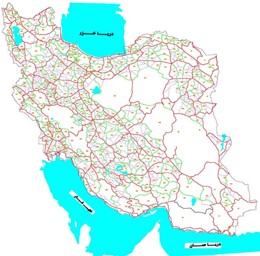
Fig. 3.6 Les réseaux nationaux de nivellement du 1 er (en rouge), 2 ème (en vert) et 3 ème (en violet) ordre en Iran
