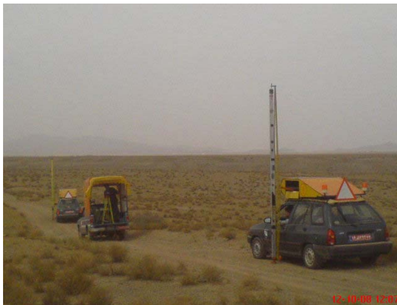
Fig. 2.12 Le système Nivellement motorisé en Iran (Poursharifi et al., 2008)
