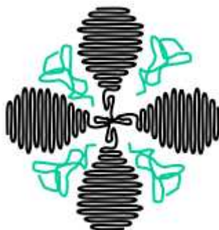
Figure I.2. Représentation spatiale d'un type de sphérolite
