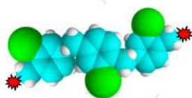
Figure II.9. Forme d'oligomère de parylène C suite à une réaction d'initiation
