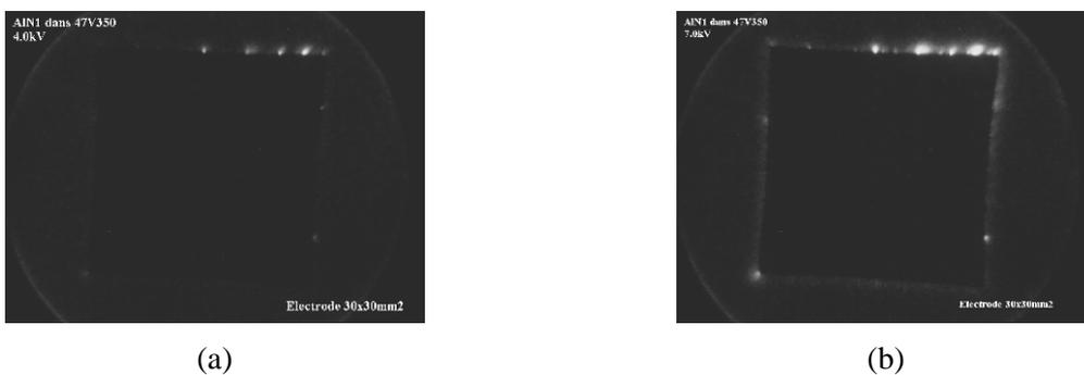
Figure II - 10 : Localisation de la lumière émise sur le substrat AIN1 dans l'huile silicone Rhodorsil 47V350, a :  $4kV_{eff}$  et b :  $7kV_{eff}$ .
