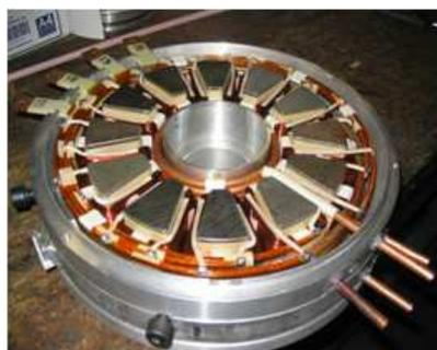
(a) Stator à flux axial
