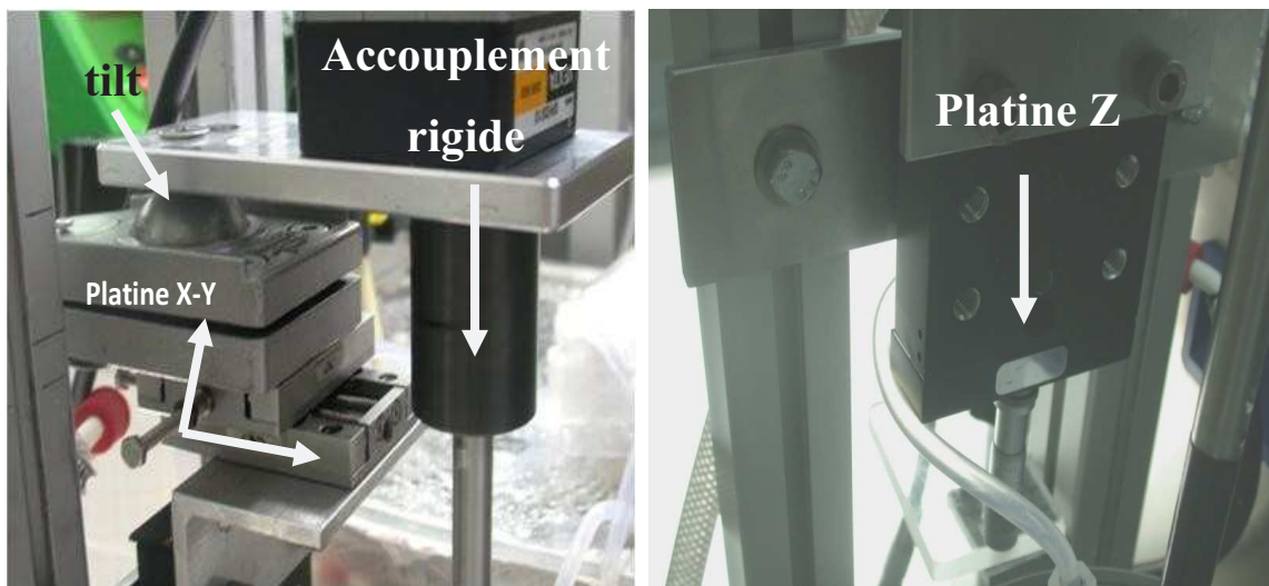
Figure 12: Photos des différentes platines X-Y, Z et du tilt utiles pour l'alignement du moteur par rapport à l'axe de la plateforme
