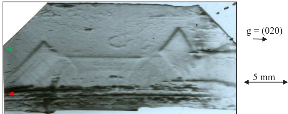
Figure 24 : Cliché de topographie aux RX enregistré au laboratoire en condition de faible absorption ( \mu.t=1,9 ), les zones contraintes apparaissent en sombre : ● zone de fortes contraintes, ● zone de faibles contraintes
