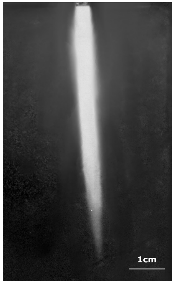
Photographie 2: partie d'un monocristal de composition \text{La}_{1.2}\text{Sr}_{1.6}\text{Ca}_{0.2}\text{Mn}_2\text{O}_7 , mesurant environ 6cm, prise dans un faisceau de neutrons d'une hauteur équivalente diffracté par un plan (006).
