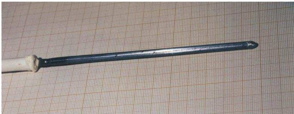
Photographie 1: massif contenant un cristal de composition \text{La}_{1.2}\text{Sr}_{1.7}\text{Ca}_{0.1}\text{Mn}_2\text{O}_7 monodomaine sur toute la section. La facette réfléchissante correspond au plan (\vec{a}, \vec{b}) .
