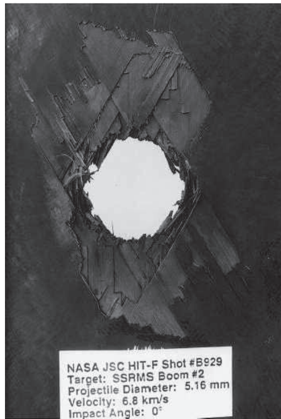
Fig. 1.1: Photographie d'une surface délaminée après impact, face frontale [1]
