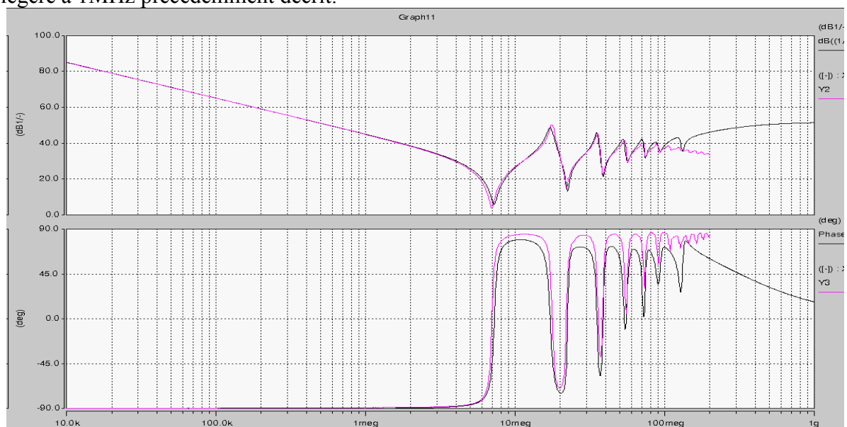
Figure II.12.1-2 Impédance du câble en circuit ouvert en \text{dB}\Omega abscisses en Hertz (noir) : modèle IDEM (rose) : mesure
