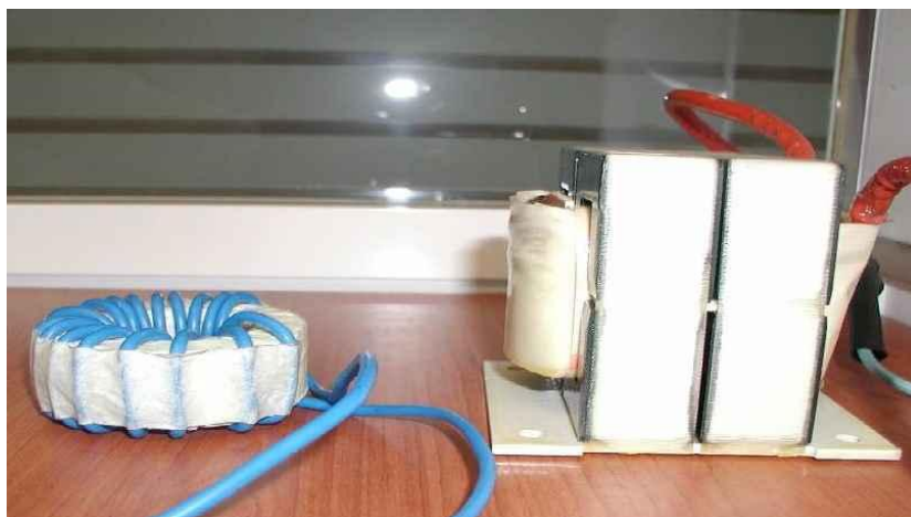
Figure IV.3.4.3-1 Comparaison des volumes des deux inductances à performances électriques égales
