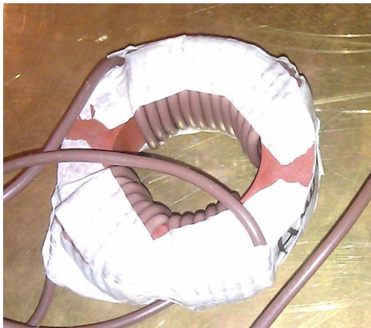
Figure V.1.3.2-1 Inductance de mode commun biphasee 13.7mH pour l'entrée
