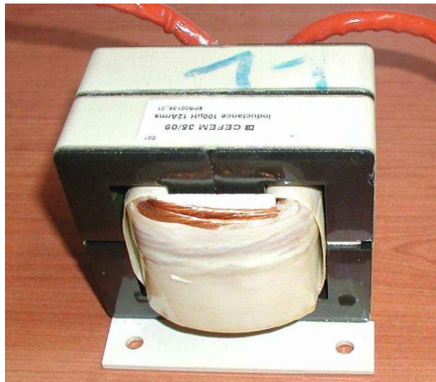
Figure IV.3.4-1 Inductance de couplage réalisée en ferrite
