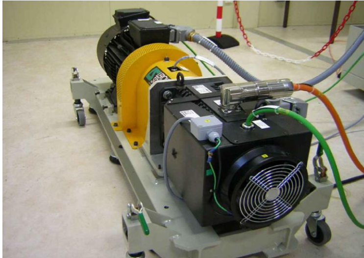
Figure II.13.1-1 Vue du banc moteur de haut en bas le moteur asynchrone servant de charge, le couplage et la machine synchrone
