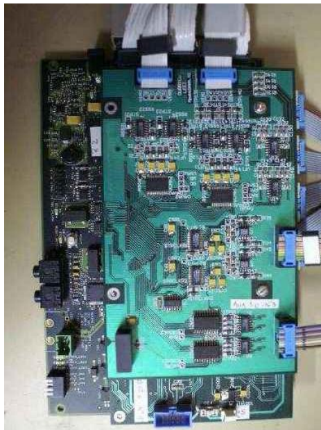
figure IV.4-2 : Cartes DSK 6713, MPAB_NUM et MPAB_ANA superposées
