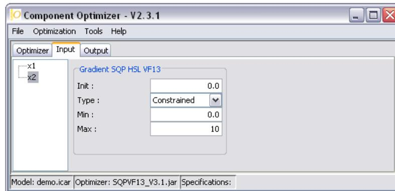
FIGURE 3.8 – Une copie d'écran de l'optimiseur CADES, ajout d'une spécification (contrainte  $c_2$ ) pour la variable  $x_2$
