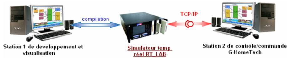
FIGURE 15.5 – Architecture matérielle G-HomeTech et simulateur temps réel RT-LAB
