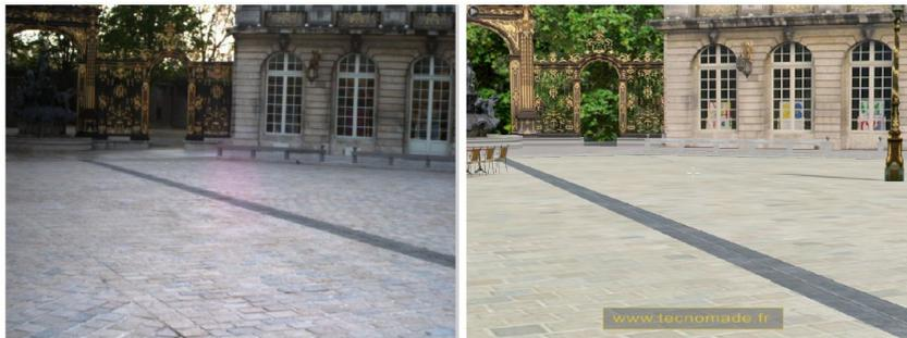
FIGURE 1.1 – **Utilisation de modèles 3D texturés.** Il est possible de mettre en correspondance l'image courante (à gauche) avec une image de synthèse générée à partir du SIG (à droite) (*extrait de Cappelle et al. (2010)*).
