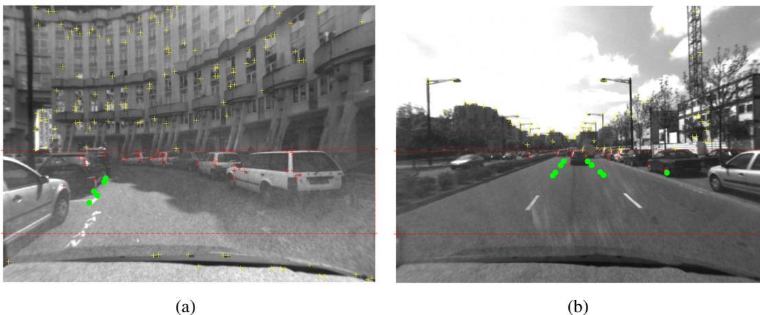
FIGURE 7.7 – **Exemples de résultats obtenus avec la sélection locale.** Les croix rouges sont les points d'intérêt détectés dans la zone route et les ronds verts sont ceux retenus par la méthode locale.
