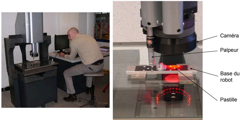
FIGURE 5.11 – Mesure par vision de la position des pastilles de la mire de référence.
