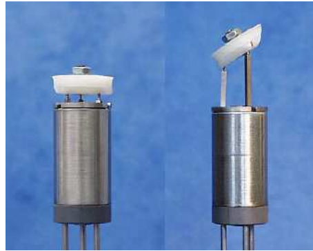
FIGURE 2.39 – Système à transmission hydraulique par Peirs et al. [PRB99].
