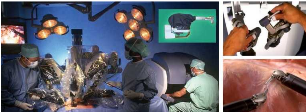
FIGURE 1.10 – Le système Da Vinci complet : les bras esclaves, l'interface haptique de commande et les instruments invasifs [dav].
